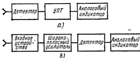
Рис. 10.6. Структурные схемы аналоговых электронных вольтметров переменного напряжения:
