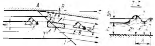
Рис. 4.15. Расчетная схема крутой волны (косого прыжка):
