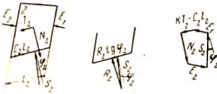
Рис. 8-18. Построение многоугольника сил для одного отсека
