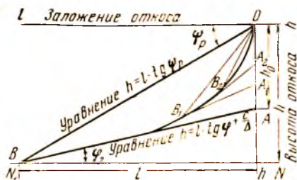
Рис. 8-21. Схема к расчету устойчивости откоса в однородной толще по методу М. Н. Троицкой
