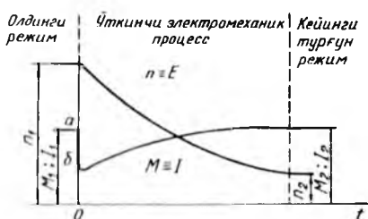
247- расм. Якорь занжирга қўшимча қаршилик киритиб двигателнинг айланиш частотасини ростлаш жараёни. Бунда: R_{ю2} > R_{ю1} ;
