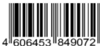
Рис. 1. Одномерный штриховой код Штриховой код представляет собой графический символ, состоящий из комбинации темных полос (штрихов) и светлых пробелов между ними. В нем содержится информация, зашифрованная с помощью цифр, букв, других знаков, каждому из которых соответствует определенная группа штрихов и пробелов различной ширины.
