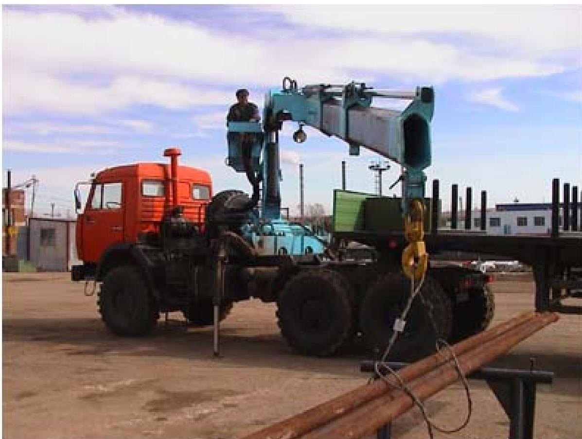
**Рис. 3.48. Агрегат АПС для перевозки штанг и НКТ**
