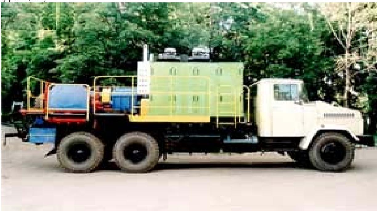
**Рис.3.23. Установка для гидроразрыва пласта УН-450x700**
