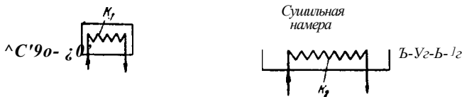
Рис. XV-5. Принципиальная схема конвективной сушилки непрерывного действия (основной вариант процесса сушки).
