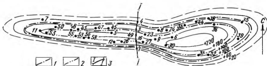
Рис. 22. Структурная карта нефтяного месторождения Нефтебад по кровле II продуктивного горизонта палеогена (по материалам объединения «Узбекнефть»).
