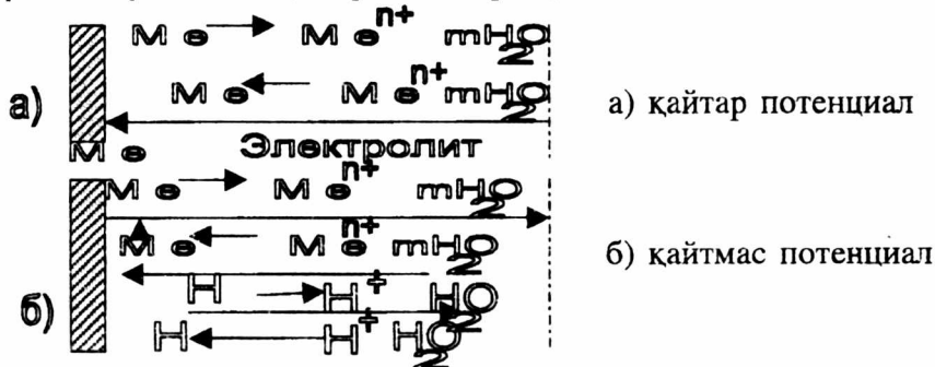
9 – расм. Металларда қайтар ва қайтмас электрод потенциалларини ҳосил бўлиш чизмаси.
