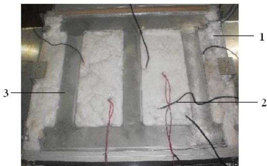
14.5-rasm. Sovituvchi rezervuar va issiqlik izolyasion materialni joylashtirish tartibi
