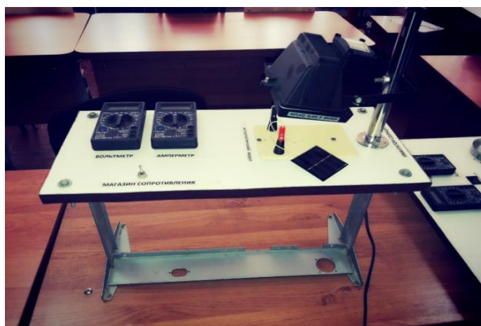
7.1.rasm. QE ning voltamper xarakteristikasini o‘rganish uchun eksperimental qurilma
