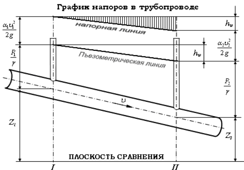
Рис.5.1. Кинематические характеристики потока для трубопровода постоянного сечения
