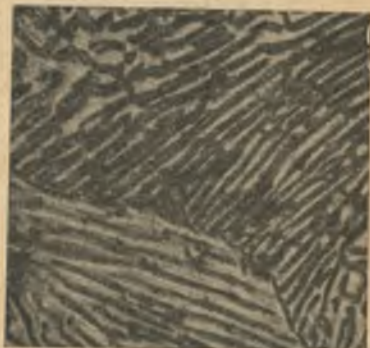
24-расм. Эвтектоидавий пулатнинг микроскопик тузилиши (1000 марта катталаштирилган).
