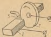
198-расм. Металлни электр-контакт усулида қирқиш схемаси.
