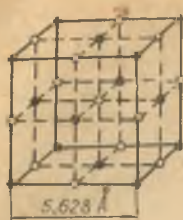
20- расм. а — NaCl нинг кристалл панжараси; б — Fe_3C нинг кристалл панжараси.
