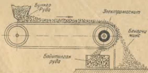
66-расм. Электромагнитавий сепараторнинг схемаси.
