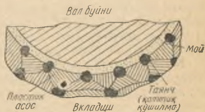
88-расм. Вкладиш билан вал бўйинининг ишлаш шароитини акс эттирувчи схема.
