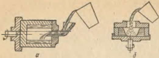
125-расм. Марказдан қочирма қуйиш машиналарининг схемаси:
