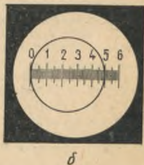
46-расм. Из диаметрини ўлчаш микроскопининг схемаси (а) ва из диаметрини микроскоп шкаласи бўйича ўлчаш (б):
