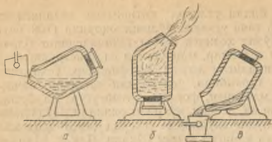
71- расм. Конверторнинг суюқ чўян қуйиш-вақтидаги (а), иш вақтидаги (б) ва тайёр пулатни қуйиб олиш вақтидаги (в) вазиятлари (схема).
