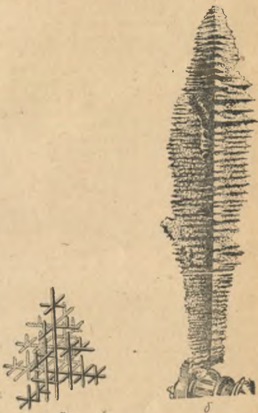
15-расм. а — дендритнинг схемаси; б — Д. К. Чернов кристалли.
