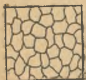
18-расм. Қаттиқ эритманинг микроскопик тузилиши (схема).
