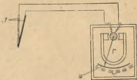
11-расм. Термоэлектрик пирометрнинг схемаси.
