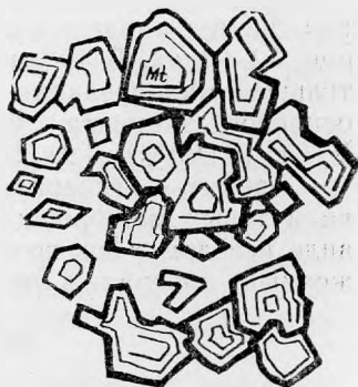
Рис. 56. Мартитизация магнетита в скарнах по отдельным зонам (месторождение Гава). Полированный шлиф. Ув. 30.
