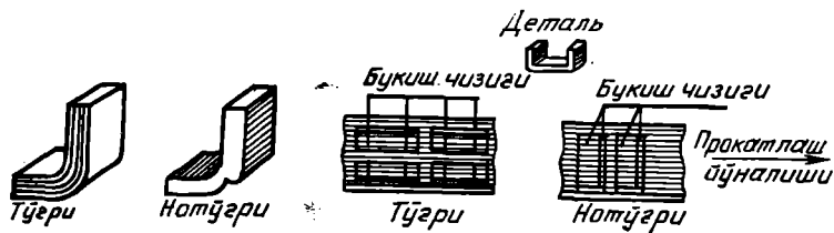
123- расм. Листларни букишда толалар йўналишининг таъсири.
