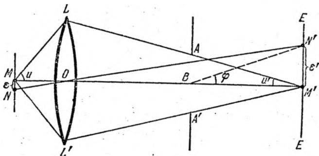
Рис. 15.2. К вычислению разрешающей силы микроскопа.
