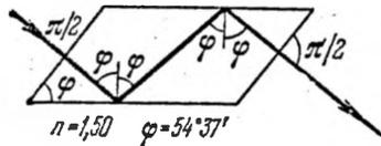
Рис. 24.5. Параллелепипед Френеля.
