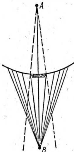
Рис. 8.13. Схема дифракции на круглом диске.
