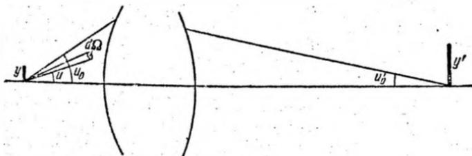
Рис. 14.23. К расчету яркости изображения в оптической системе.
