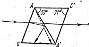
Рис. 17.5. Укороченная поляризационная призма с воздушной прослойкой.
