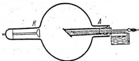
Рис. 19.2. Схема рентгеновской трубки.
