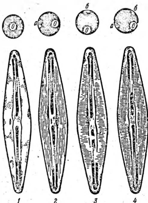
Рис. 15.5. Влияние характера освещения на изображение в микроскопе.
