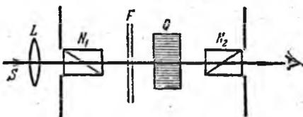
Рис. 30.1. Схема наблюдения вращения плоскости поляризации в кристалле.
