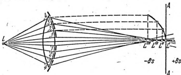
Рис. 13.2. Сферическая aberrация и ее графическое изображение.
