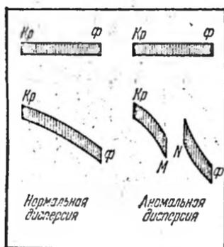
Рис. 28.2. Вид спектра, получаемого по методу скрещенных призм.
