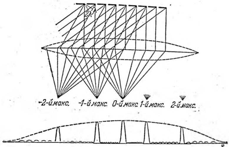
Рис. 9.18. К теории дифракционной решетки. Положение главных максимумов и распределение энергии по различным порядкам в щелевой решетке.
