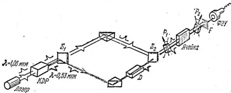
Рис. 27.5. Схема для определения времени исчезновения двойного лучепреломления.
