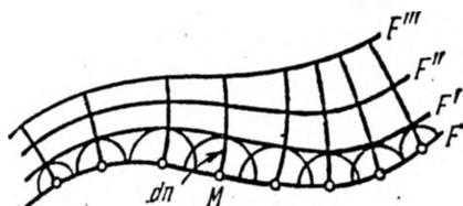
Рис. 12.1. К принципу Ферма: последовательное построение волнового фронта.
