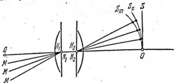
Рис. 13.6. Искривление плоскости изображения.
