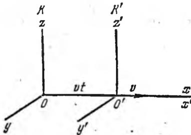
Рис. 22.1. Две инерциальные системы координат.
