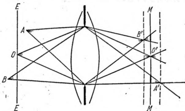
Рис. 14.1. Влияние диафрагмы на глубину резкого изображения.
