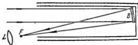
Рис. 14.17. Схема рефлектора Ломоносова — Гершеля.
