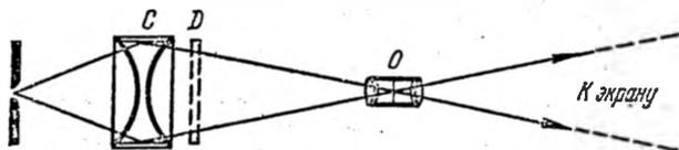
Рис. 14.20. Схематическое изображение хода лучей в проекционном устройстве. Конденсор *C* проектирует источник света на входную зрачку объектива *O*. Объектив *O* проектирует диапозитив *D* на удаленный экран.
