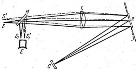
Рис. 20.6. Определение скорости света методом вращающегося зеркала.
