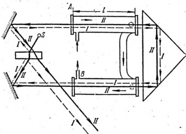
Рис. 22.2. Схема опыта Физо.
