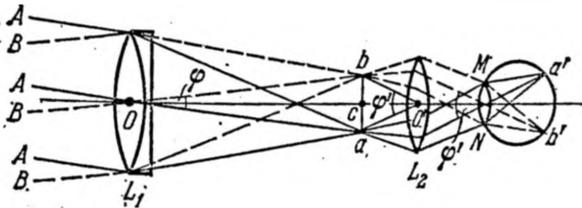
Рис. 14.14. Схематическое изображение хода лучей в зрительной трубе.
