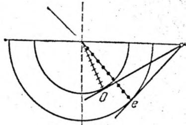
Рис. 26.20. Построение Гюйгенса для случая, изображенного на рис. 26.19.
