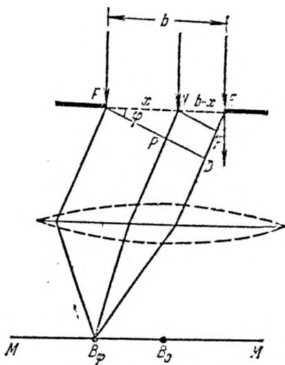
Рис. 9.1. Дифракция на щели. Графическое вычисление результирующей амплитуды для разных направлений.
