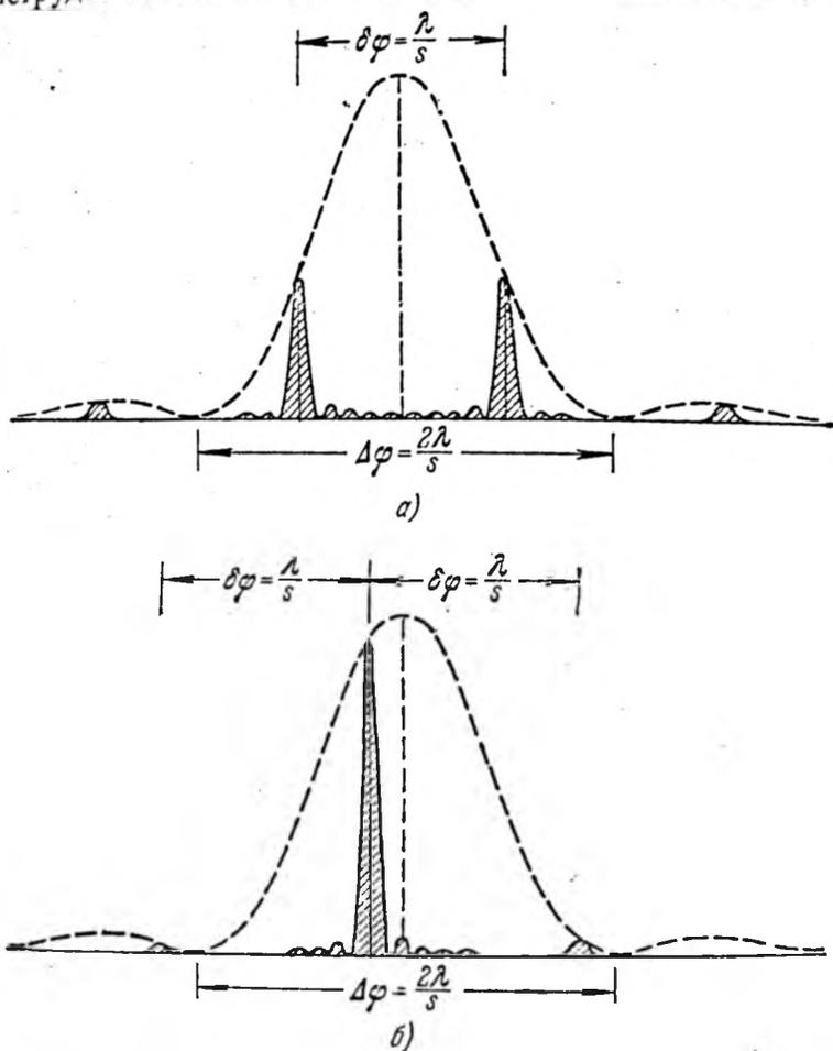
Рис. 9.26. Два возможных положения главных максимумов в эшелоне Майкельсона.
