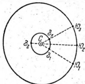
Рис. 20.1. К определению скорости света, по методу Рёмера.
