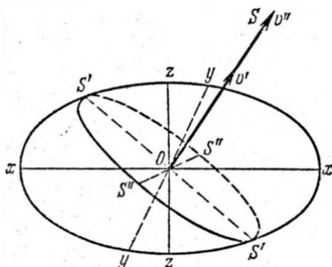
Рис. 26.5. Нахождение  $v'$  и  $v''$  с помощью эллипсоида Френеля.
