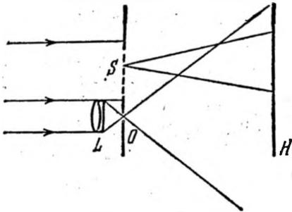
Рис. 11.10. Схема получения голограмм Фурье.
