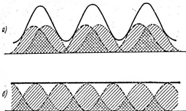
Рис. 4.12. Наложение интерференционных картин, сдвинутых друг относительно друга.
