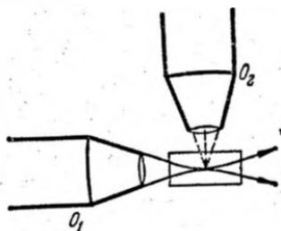
Рис. 15.8. Схема простейшего ультрамикроскопа.
