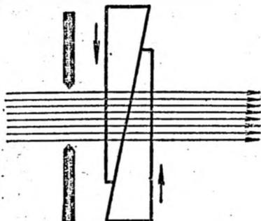
Рис. 3.7. Фотометрический ослабитель: поглощающий клин.
