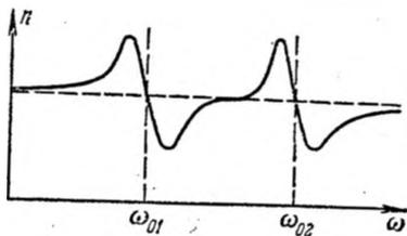
Рис. 28.11. Кривая дисперсии при наличии нескольких полос поглощения.
