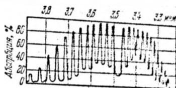
Рис. 38.8. Спектр поглощения пара хлористого водорода в близкой инфракрасной области.
