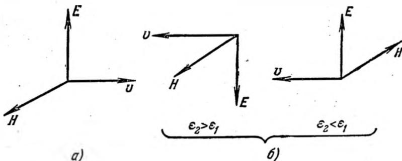
Рис. 5.1. Расположение векторов  $E$ ,  $H$  и  $v$  в падающей (а) и в отраженной (б) волнах.
