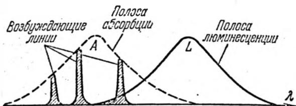
Рис. 39.4. При возбуждении светом любой частоты, лежащей в пределах одной полосы поглощения, спектр люминесценции остается неизменным.
