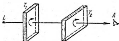
Рис. 16.1. Прохождение света через две пластинки турмалина.
