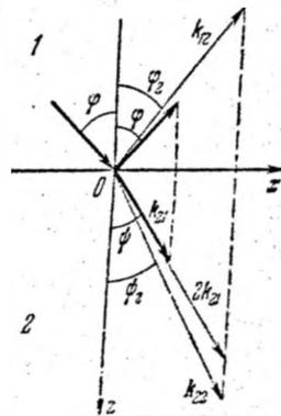
Рис. 41.11. Отражение и преломление волн на границе раздела между линейной (1) и нелинейной (2) средами.
