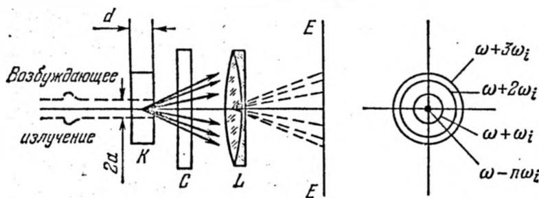
Рис. 41.14. Схема опыта по наблюдению за ВКР.
