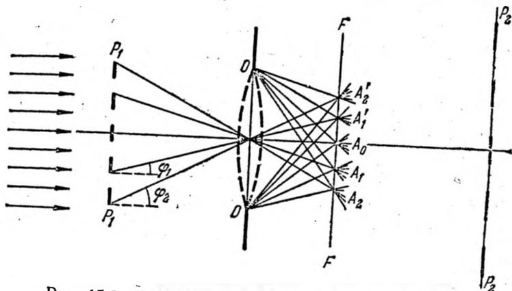
Рис. 15.3. К дифракционной теории микроскопа Аббе.
