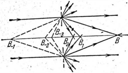
Рис. 8.6. Совокупность фокусов амплитудной зонной пластинки.
