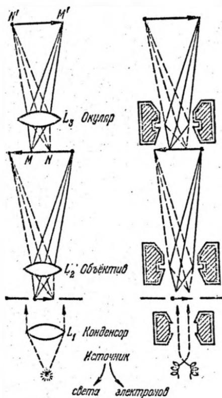
Рис. 15.6. Схема устройства электронного микроскопа.
