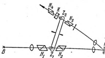
Рис. 39.9. Схема фосфороскопа с применением высокочастотной модуляции света, обеспечивающего измерения длительности возбужденного состояния до  $10^{-8}$ — $10^{-9}$  с.
