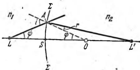
Рис. 12.10. Преломление параксиальных лучей на сферической границе двух сред.
