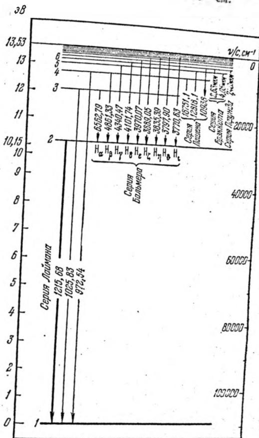
Рис. 38.3. Схема энергетических уровней атома водорода.
