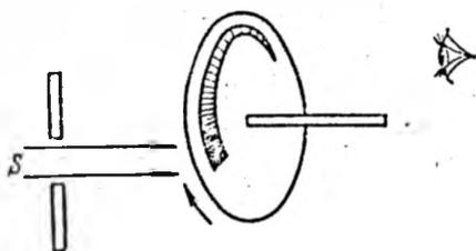
Рис. 39.8. Схема фосфороскопа, обеспечивающего измерения длительности возбужденного состояния до  $10^{-5}$ — $10^{-6}$  с.
