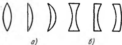
Рис. 12.17. Различные типы тонких линз.
