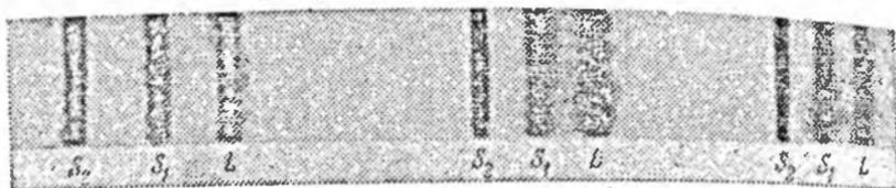
Рис. 29.11. Спектр вынужденного рассеяния Мандельштама — Бриллюэна в плавленом кварце.
