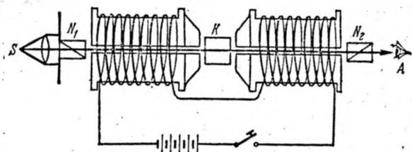
Рис. 30.9 Схема наблюдения магнитного вращения плоскости поляризации.
