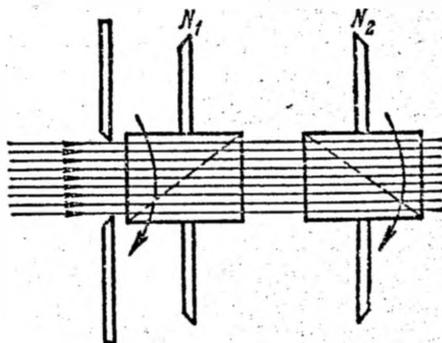
Рис. 3.9. Фотометрический ослабитель: система двух поляризационных призм.
