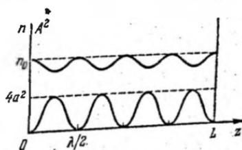
Рис. 41.4. Изменение квадрата амплитуды поля и показателя преломления вдоль оси лазера.
