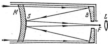
Рис. 14.19. Схема одного из менисковых телескопов Д. Д. Максудова.
