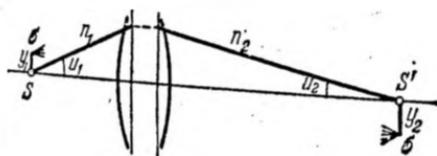
Рис. 13.9. Апланатические точки системы.
