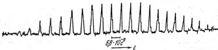
Рис. 40.19. Временная зависимость мощности излучения лазера, работающего в режиме сверхкоротких импульсов.
