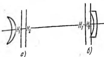
Рис. 12.23. Расположение главных плоскостей в собирающей (а) и рассеивающей (б) линзах-менисках.
