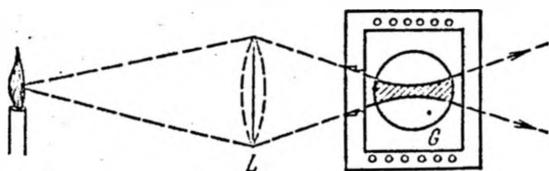
Рис 38.4. Схема опытов по резонансному возбуждению паров натрия.
