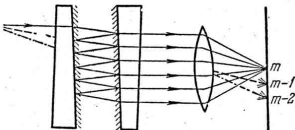
Рис. 7.4. Схематическое представление интерференционного эталона Фабри — Перо.
