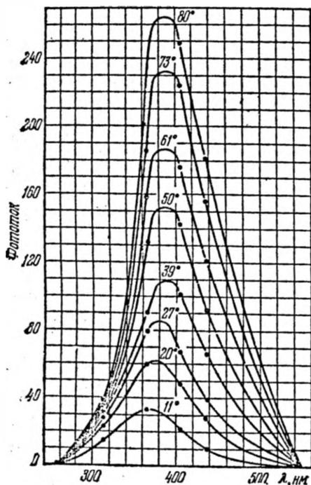
Рис. 32.10. Зависимость величины селективного фотоэффекта от угла падения.
