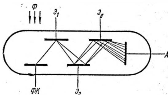
Рис. 32.12. Схема устройства фотоумножителя.
