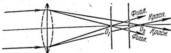
Рис. 13.16. Хроматическая aberrация простой линзы.
