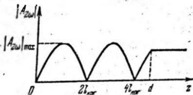
Рис. 41.10. Зависимость модуля амплитуды второй гармоники ( $A_{2\omega}$ ) от расстояния  $z$ .
