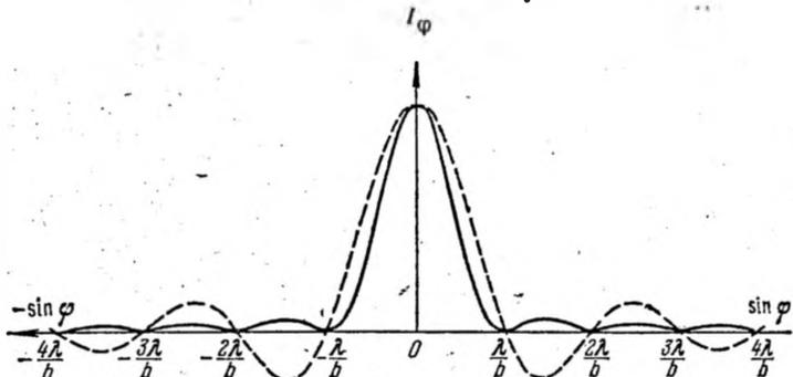
Рис. 9.3. Зависимость интенсивности (сплошная кривая) и амплитуды (пунктирная кривая) от направления при дифракции на щели.
