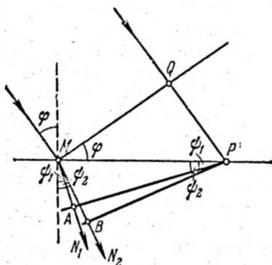
Рис. 26.12. Нахождение направления нормалей в анизотропной среде с помощью построения Гюйгенса.
