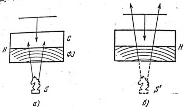
Рис. 11.14. Схема получения объемных голограмм с помощью встречных пучков.
