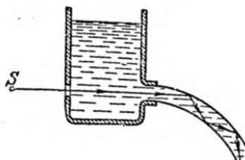
Рис. 24.2. Явление полного отражения в струе жидкости.
