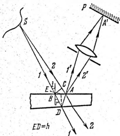
Рис. 6.4. К расчету разности хода при интерференции световых пучков на тонком прозрачном клине.
