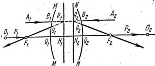
Рис. 12.21. Главные плоскости  $H_1R_1$  и  $H_2R_2$  и фокусы  $F_1$  и  $F_2$  оптической системы.
