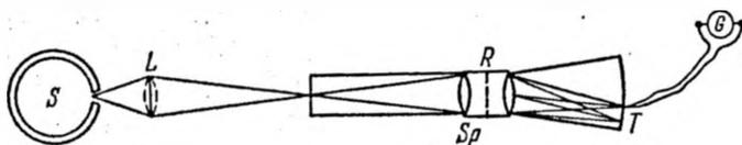
Рис. 36.8. Схема опытов по исследованию распределения энергии в спектре черного тела.
