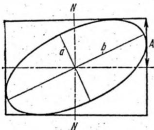
Рис. 18.4. Зависимость интенсивности эллиптически-поляризованного света, проходящего через николь, от ориентации николя.
