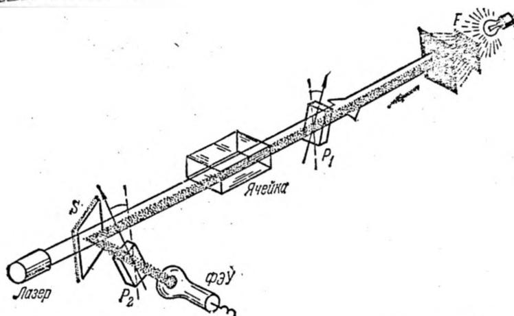
Рис. 27.4. Принципиальная схема опыта по созданию двойного лучепреломления под действием мощного импульса света.
