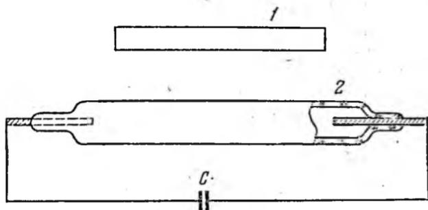
Рис. 40.6. Схема рубинового лазера.
