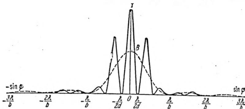
Рис. 9.11. Распределение интенсивности при дифракции на двух параллельных щелях шириной  $b$ , расположенных на расстоянии  $d$ .
