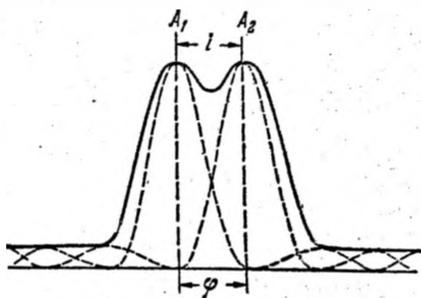
Рис. 15.13. Распределение интенсивности при наложении двух близких спектральных линий.
