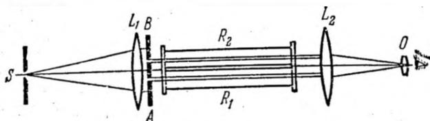
Рис. 9.12. Схема интерферометра Рэлея.
