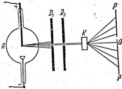
Рис. 19.3. Схема опыта Лауэ.
