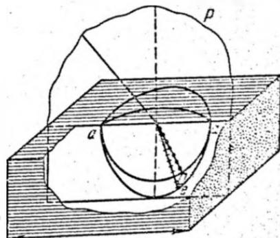
Рис. 26.16. Прохождение света через пластинку одноосного кристалла, вырезанную параллельно оптической оси; плоскость падения совпадает с главной плоскостью кристалла.
