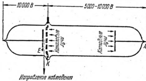
Рис. 31.8. Схема трубки для наблюдения эффекта Штарка.
