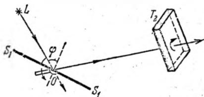
Рис. 16.2. Исследование поляризации при отражении.
