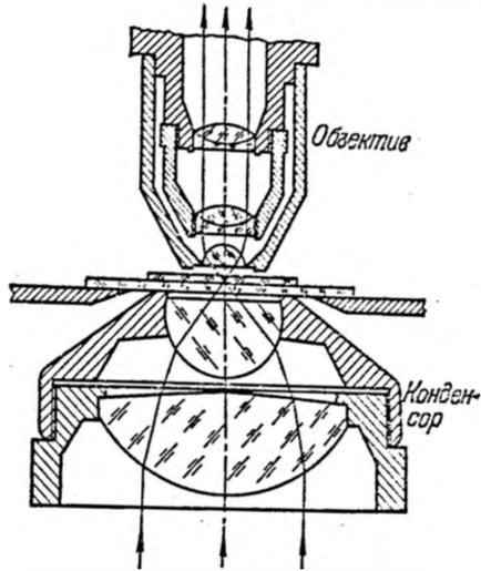
Рис. 14.13. Разрез конденсора и несложного объектива микроскопа.
