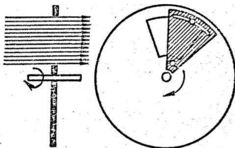
Рис. 3.8. Фотометрический ослабитель: вращающийся диск с вырезом.
