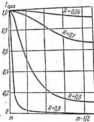
Фиг. 7.6. Зависимость интенсивности в полосах интерференции от разности хода при разных значениях  $R$  ( $I_0 = 1$ ).
