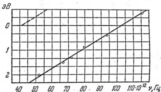
Рис. 32.5. Зависимость энергии фотоэлектронов от частоты.
