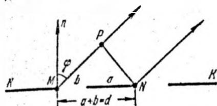
Рис. 9.10. К определению положения главных максимумов и добавочных минимумов при дифракции на двух параллельных щелях.
