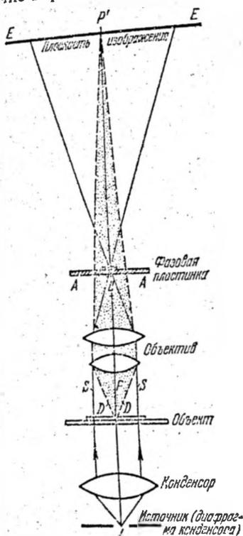
Рис. 15.10. Схема наблюдения рефракционной структуры.
