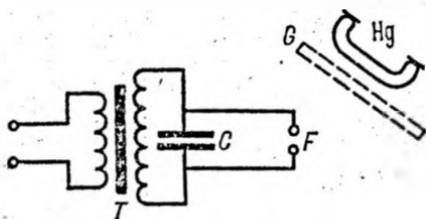
Рис. 32.1. Схема опыта Герца.
