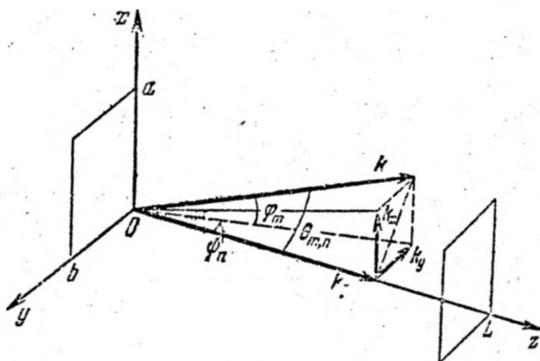
Рис. 40.15. Резонатор с плоскими прямоугольными зеркалами
