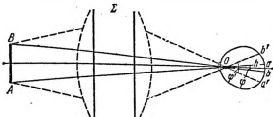
Рис. 14.10. Действие оптической системы на видимый угловой размер изображения.  $O$  — оптический центр глаза;  $h$  — глубина глаза;  $AB$  — предмет;  $ab$  — его изображение в невооруженном глазу;  $\varphi$  — угол зрения невооруженного глаза;  $a'b'$  — изображение предмета в глазу, вооруженном оптической системой  $\Sigma$ ;  $\varphi'$  — угол зрения вооруженного глаза.
