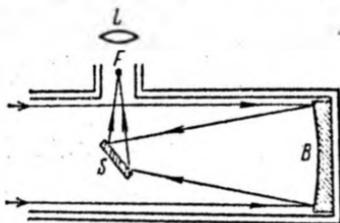
Рис. 14.16. Схема рефлектора Ньютона.
