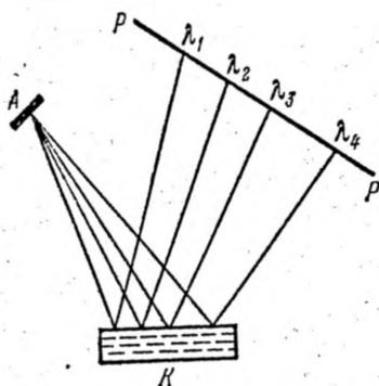
Рис. 19.5. Схема спектрографии рентгеновских лучей методом широкого пучка.
