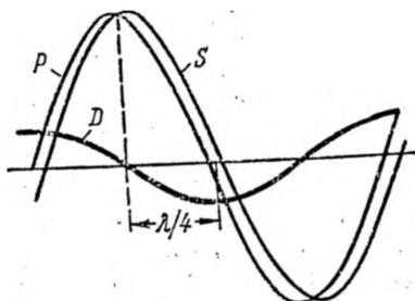
Рис. 15.11. Образование дифрагированной волны  $D$  при наблюдении рефракционной структуры.
