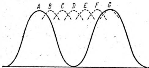
Рис. 4.16. Распределение максимумов интерференции немонохроматических лучей.
