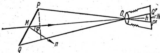
Рис. 14.22. К выводу зависимости освещенности изображения от яркости предмета и параметров оптической системы.
