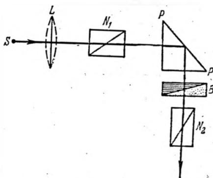
Рис. 24.4. Наблюдение эллиптической поляризации света при явлении полного внутреннего отражения.
