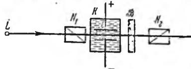
Рис. 27.2. Схема расположения приборов для наблюдения двойного лучепреломления в электрическом поле.
