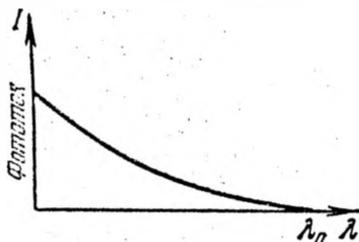
Рис. 32.7. Зависимость силы фототока от длины волны.
