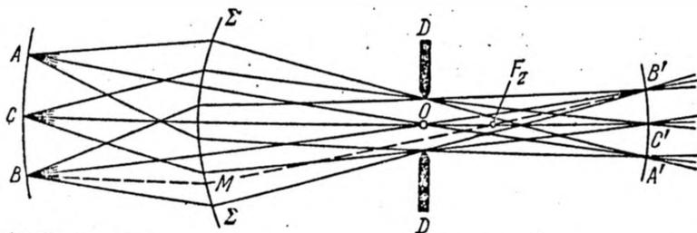
Рис. 12.12. Изображение малого предмета  $ACB$  при преломлении на сферической поверхности.
