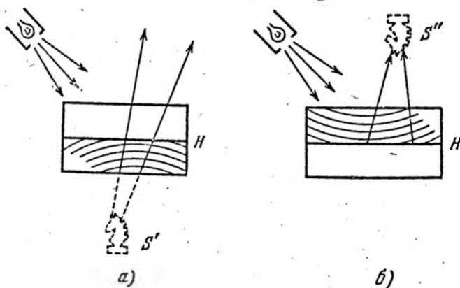
Рис. 11.15. Восстановление главного (а) и дополнительного (б) изображений при просвечивании объемной голограммы некогерентным светом.
