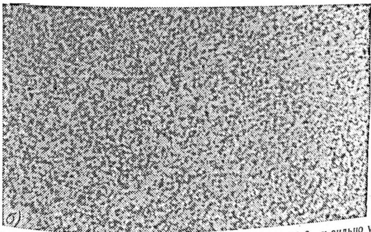
Рис. 11.7. Голограмма объектов (а), изображенных на рис. 11.6., и сильно увеличенный ее участок (б).
