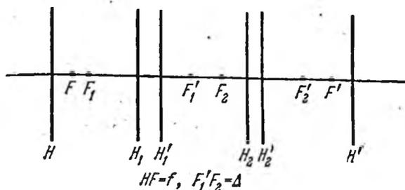
Рис. 12.28. К определению параметров сложной оптической системы.
