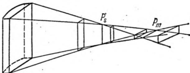
Рис. 13.8. Астигматизм цилиндрической линзы.
