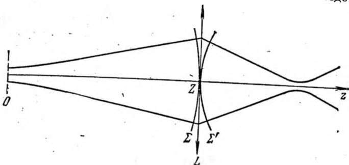
Рис. 9.9. Преобразование гауссова пучка идеальной тонкой линзой  $L$ .
