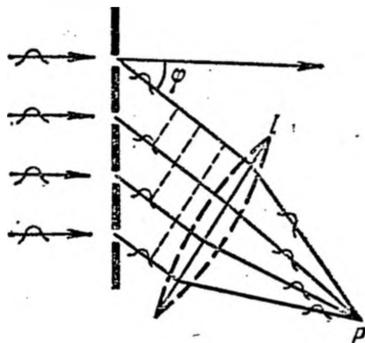
Рис. 9.30. Преобразование импульса в совокупность монохроматических волн при прохождении через дифракционную решетку.
