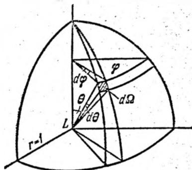
Рис. 3.2. К выводу выражения для телесного угла в полярных координатах.
