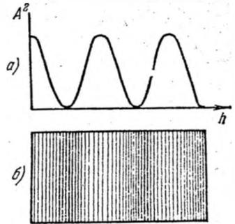
Рис. 4.6. Распределение освещенности экрана при интерференции двух лучей.
