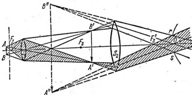
Рис. 14.12. Схематическое изображение хода лучей в микроскопе.
