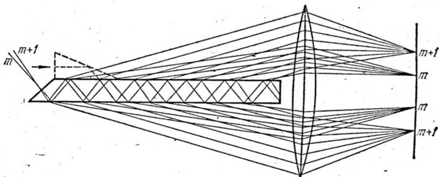
Рис. 7.7. Схема пластины Люммера — Герке.
