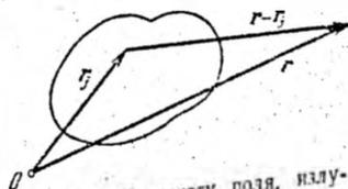
Рис. 40.1. К расчету поля, излучаемого протяженным источником света
