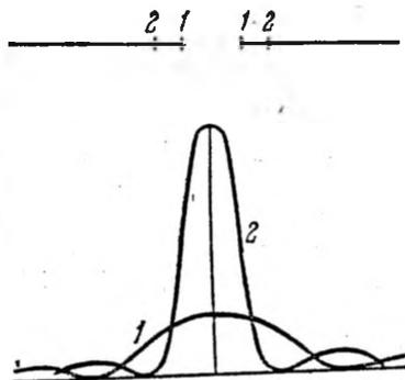
Рис. 9.4. Дифракция на щели; влияние ширины щели на распределение интенсивности.
