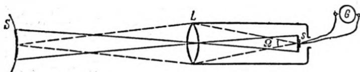
Рис. 37.1. Схема радиационного пиromетра для измерения радиационной температуры.
