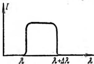
Рис. 9.29. Распределение интенсивности в спектральном интервале от  $\lambda$  до  $\lambda + \Delta\lambda$ .
