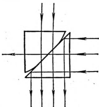
Рис. 3.11. Фотометрический кубик Люммера.
