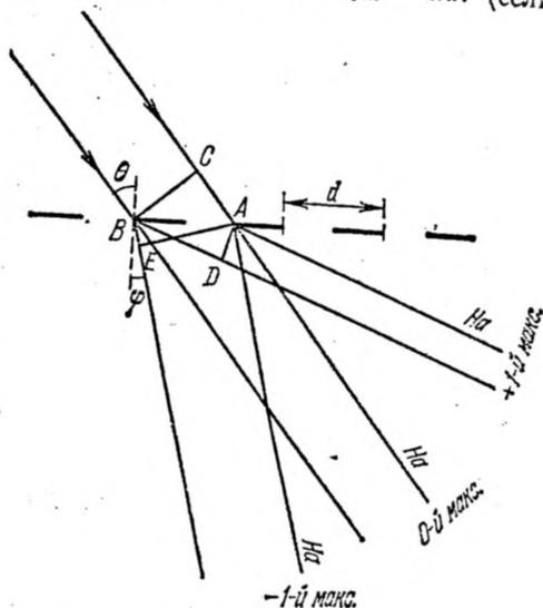
Рис. 9.21. Наклонное падение параллельного пучка на дифракционную решетку.
