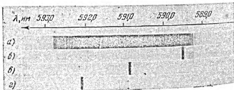
Рис. 40.23. Спектр излучения лазера на красителе.
