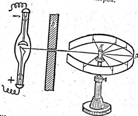
Рис. 19.7. Схема спектрографии рентгеновских лучей по методу различных ориентаций кристаллов.
