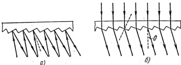
Рис. 9.22. Фазовые решетки со специальным профилем для концентрации энергии в отдельных спектрах различных порядков.
