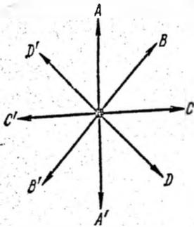
Рис. 2.7. Направления колебаний в естественной поперечной волне.
