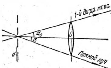
Рис. 15.4. Значение косых пучков для повышения разрешающей способности микроскопа.
