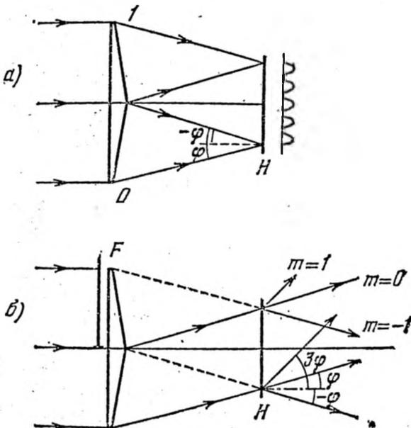
Рис. 11.3. Регистрация интерференционной картины от двух плоских волн  $O$  и  $I$  (а) (справа от  $H$  показано распределение освещенности) и восстановление волны  $I$  с помощью просвечивающей волны (б).
