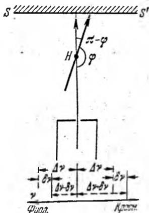
Рис. 22.10. Схема опыта Айвса по обнаружению поперечного эффекта Допплера.
