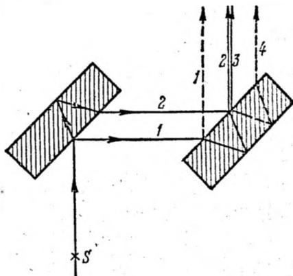
Рис. 7.1. Схема интерферометра Жамена.
