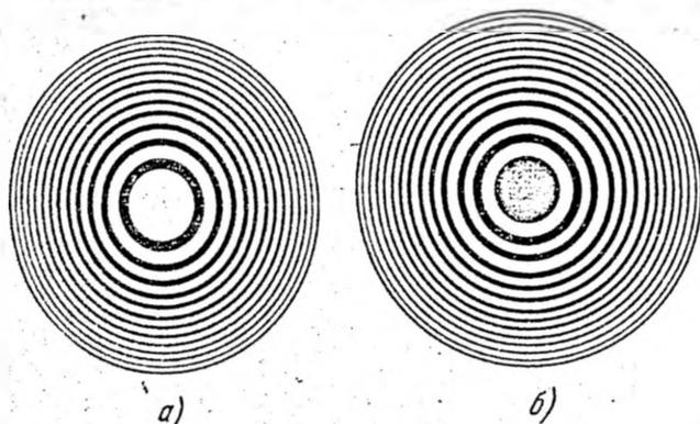
Рис. 8.5. Зонные пластинки.
