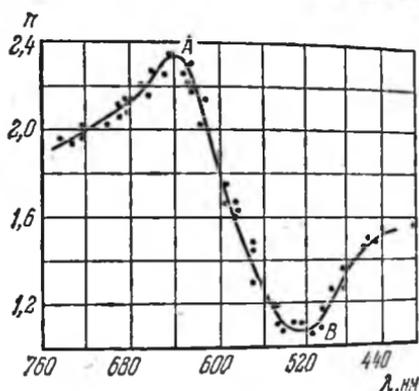
Рис. 28.3. Ход показателя преломления в цианине в области полосы поглощения.
