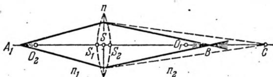
Рис. 12.15. Преломление в тонкой линзе.
