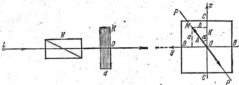
Рис. 18.1. Схема получения эллиптически-поляризованного света.
