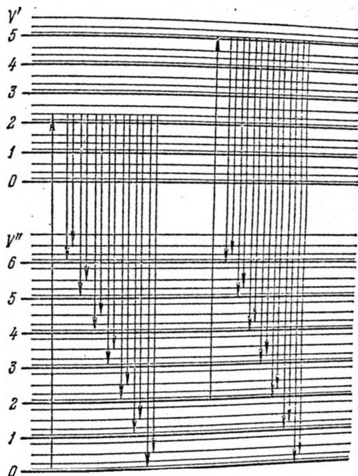
Рис. 39.1. Схема энергетических уровней молекулы, поясняющая образование сложного спектра испускания при монохроматическом возбуждении.
