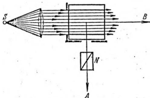
Рис. 29.2. Схема наблюдения рассеяния света в мутных средах.
