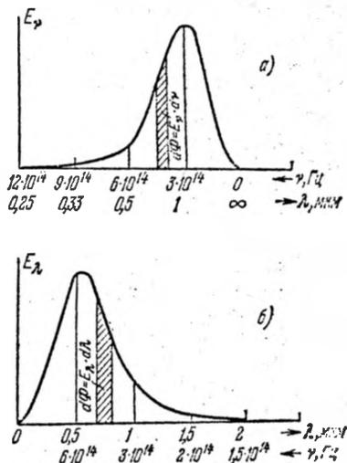
Рис. 36.3. Спектральная зависимость испускательной способности черного тела при  $T = 2900\text{ K}$ .
