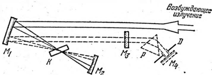
Рис. 40.22. Оптическая схема лазера на красителе.
