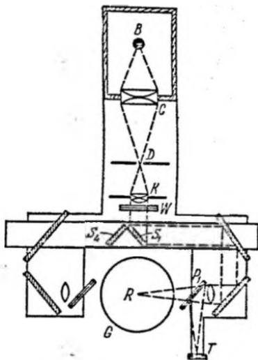
Рис. 34.1. Схема опытов П. Н. Лебедева по измерению давления света.
