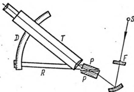
Рис. 24.3. Схема рефрактометра Аббе.
