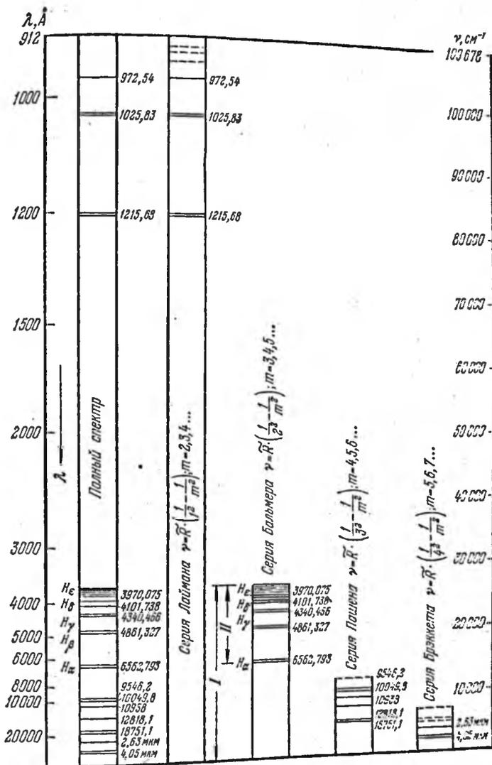
Рис. 38.1. Схематическое изображение спектра атома водорода: полный спектр и отдельные спектральные серии.
