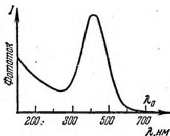
Рис. 32.8. Зависимость силы фототока от длины волны в области селективного фотоэффекта.
