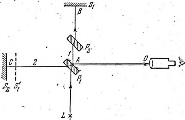
Рис. 7.2. Схема интерферометра Майкельсона.
