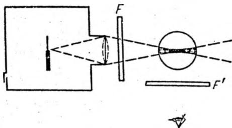
Рис. 39.2. Схема наблюдения флуоресценции жидкостей.
