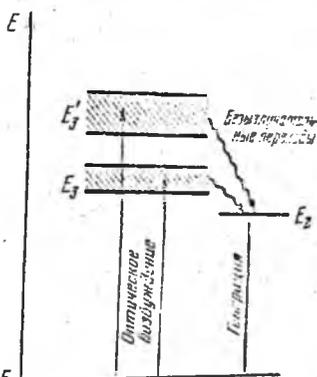
Рис. 40.5. Схема энергетических уровней иона хрома.
