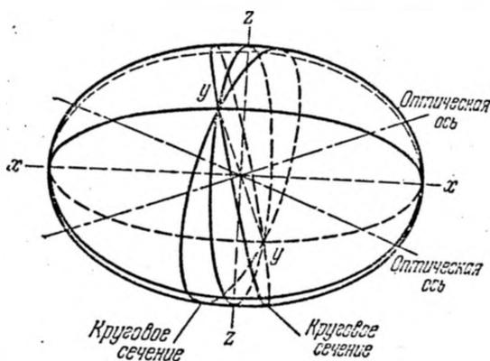
Рис. 26.9. Определение направлений оптических осей с помощью эллипсоида Френеля или эллипсоида индексов.
