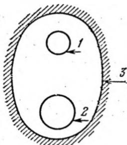
Рис. 40.7. Поперечное сечение осветителя лазера с оптическим возбуждением.
