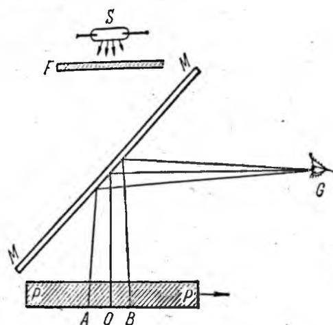
Рис. 6.7. Схема установки для интерференционного метода контроля плоскопараллельности пластины.
