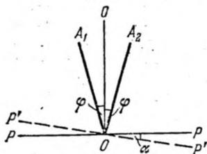
Рис. 30.3. Принцип действия полутеневого анализатора.
