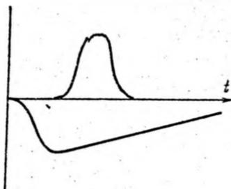
Рис. 40.8. Осциллограммы свечения возбуждающей лампы-вспышки и излучения рубинового лазера.
