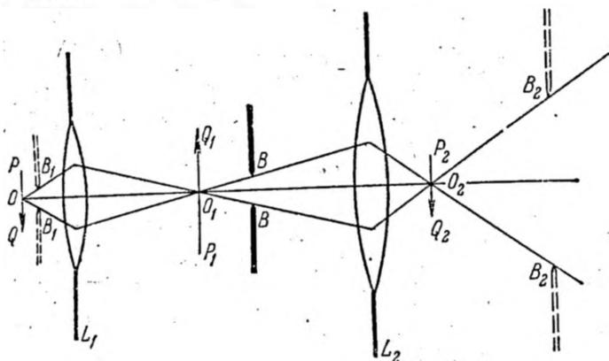
Рис. 14.2.  $BB$  — апертурная диафрагма,  $V_1V_1$  — входной зрачок и  $V_2V_2$  — выходной зрачок системы.
