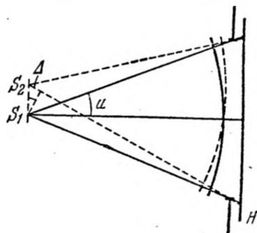
Рис. 11.12. К определению разрешающей способности голографических систем.
