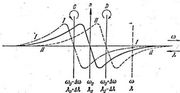
Рис. 31.7. Ход кривой дисперсии в отсутствие магнитного поля (сплошная кривая) и в магнитном поле.
