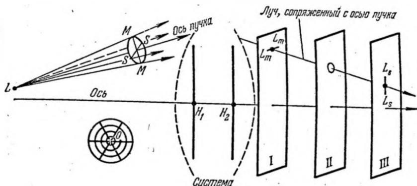
Рис. 13.5. Астигматизм наклонных пучков.
