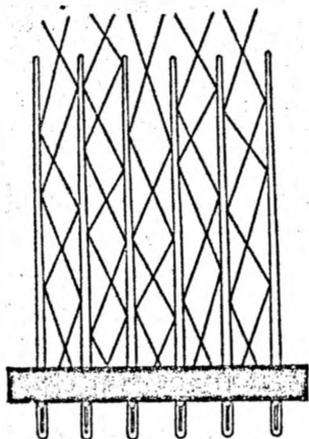
Рис. 36.5. Щетка из полированных иглолок вследствие многократных отражений обладает большой поглощательной и испускательной способностью.
