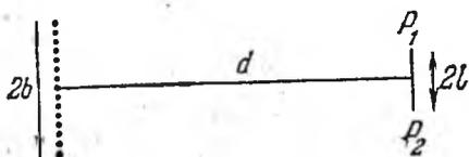
Рис. 4.21. К расчету степени пространственной когерентности  $\gamma_{12}(0)$ .
