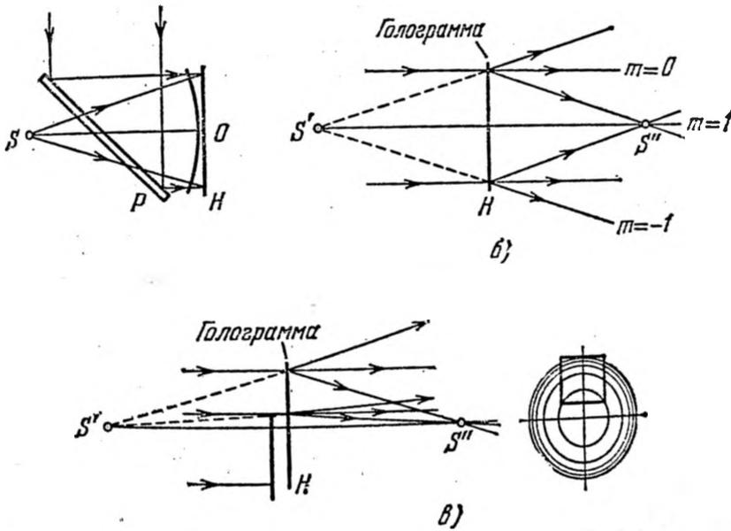
Рис. 11.4. Схема голографирования сферической волны.
