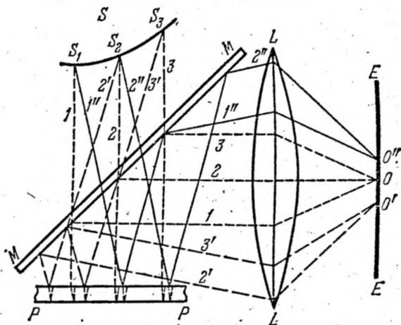
Рис. 6.6. Способ наблюдения колец равного наклона.
