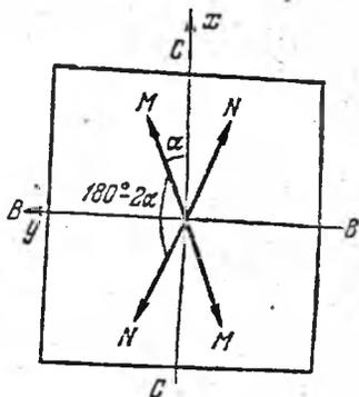
Рис. 18.2. Действие пластинки в  $1/2$  волны.
