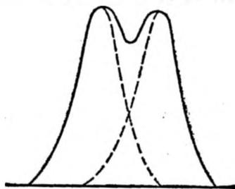
Рис. 9.28. Распределение освещенности для двух еще разрешимых спектральных линий (критерий Рэлея).
