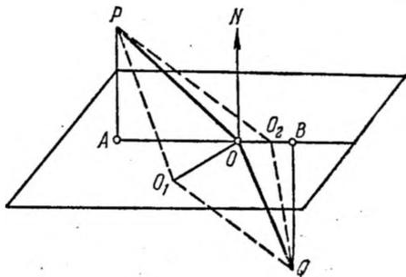
Рис. 12.3. Вывод закона преломления из принципа Ферма.
