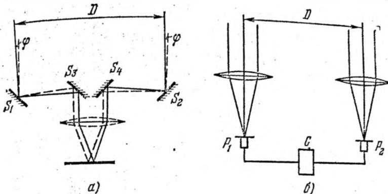
Рис. 9.15. Схемы опытов по измерению диаметра звезд, предложенных Майкельсоном (а) и Брауном и Твиссом (б).
