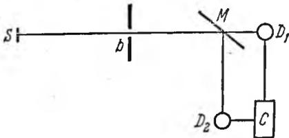
Рис. 4.24. Схема опыта для измерения корреляции интенсивностей.
