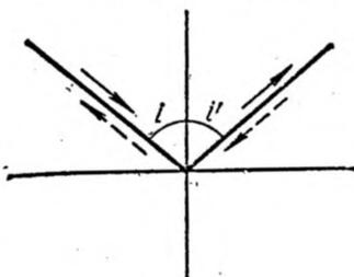
Рис. 12.9. Ход лучей при отражении света.
