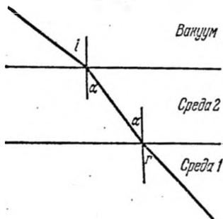
Рис. 12.7. К выводу закона взаимности при преломлении.
