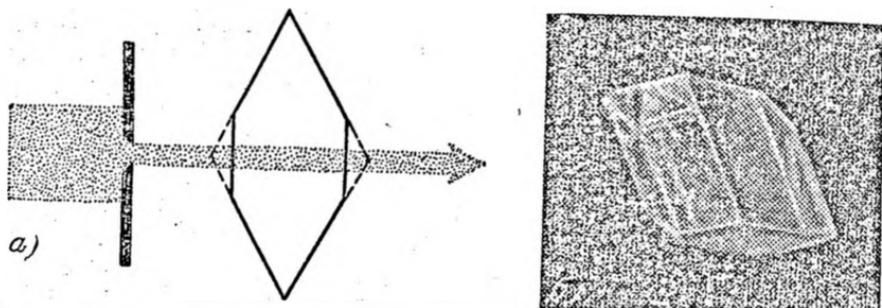
Рис. 17.3. а) Двойное лучепреломление не наблюдается при прохождении света вдоль оптической оси исландского шпата. б) Естественный кристалл исландского шпата, у которого сошлифованы две площадки, перпендикулярные к оптической оси.
