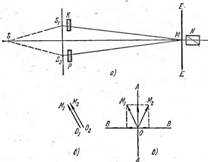
Рис. 18.3. Схема опыта С. И. Вавилова для выяснения внутренней структуры естественного света.
