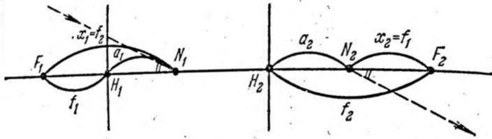
Рис. 12.25. Положение узловых точек  $N_1$  и  $N_2$ .
