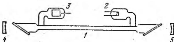
Рис. 40.10. Принципиальная схема гелий-неонового лазера.
