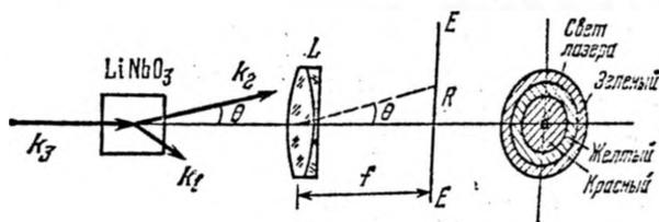
Рис. 41.12. Схема опыта по наблюдению параметрической люминесценции. Преломление на грани кристалла не принято во внимание.
