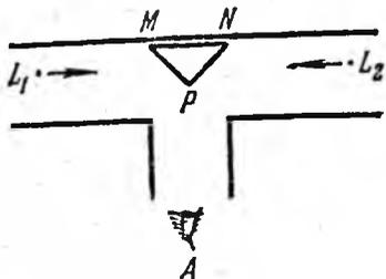
Рис. 3.10. Схема простейшего фотометра.
