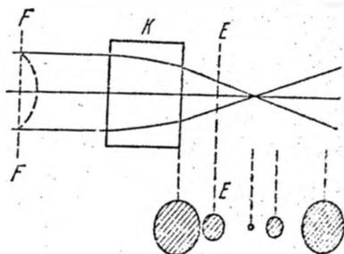
Рис. 41.1. Самофокусировка интенсивного пучка в нелинейной среде.
