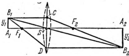
Рис. 12.19. Построение изображения в тонкой линзе.
