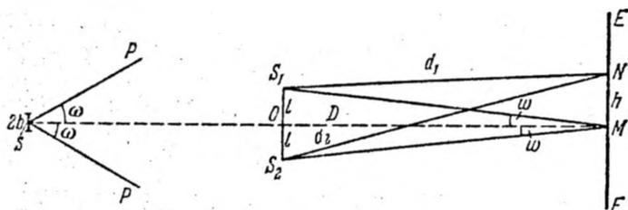
Рис. 4.5. Общая интерференционная схема.
