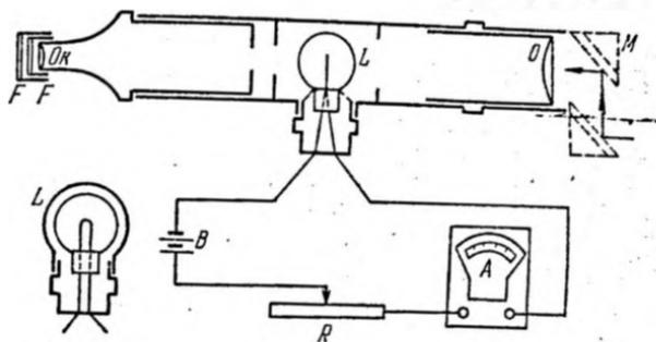
Рис. 37.3. Схема пирометра с исчезающей нитью для определения яркостной температуры.
