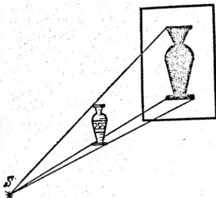
Рис. 1.1. Прямолинейное распространение света: образование тени при освещении точечным источником.
