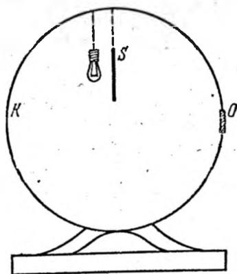
Рис. 3.14. Фотометрический шар, схематическое изображение разреза.
