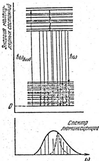
Рис. 40.21. Схема энергетических уровней сложной органической молекулы.
