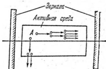
Рис. 40.4. Принципиальная схема оптического квантового генератора
