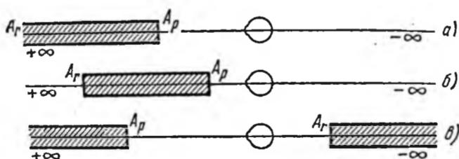
Рис. 14.9. Ближние ( $A_p$ ) и дальние ( $A_r$ ) точки аккомодации для глаза нормального (а), близорукого (б) и дальнозоркого (в).
