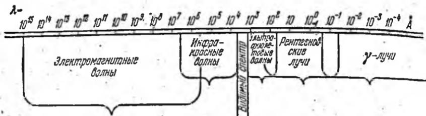
Рис. 19.9. Шкала электромагнитных волн.
