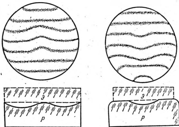
Рис. 7.10. Интерференционный метод контроля поверхности.
