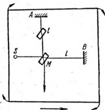
Рис. 22.5. Схема опыта Майкельсона.
