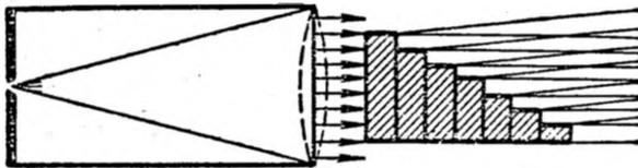
Рис. 9.24. Схема эшелона Майкельсона.
