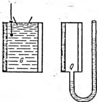
Рис. 36.1. Приборы для демонстрации правила Прево.
