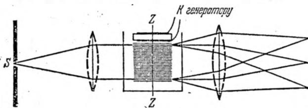
Рис. 10.4. Схема наблюдения дифракции на ультразвуковых волнах.
