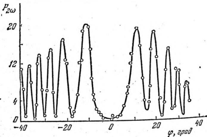
Рис. 41.7. Зависимость мощности  $P_{2\omega}$  (произвольные единицы) второй гармоники излучения рубинового лазера от угла падения  $\varphi$  на пластинку кристаллического кварца.
