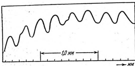
Рис. 4.2. Интерференционная картина, полученная с двумя световыми пучками от двух разных лазеров.
