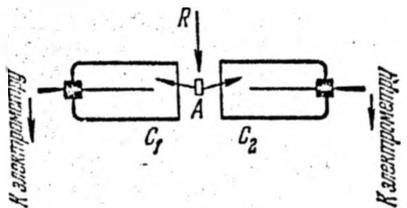
Рис. 32.6. Схема опыта Боте.
