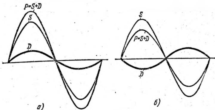
Рис. 15.12. Принцип метода фазового контраста.
