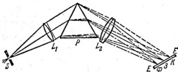
Рис. 14.21. Схематическое изображение хода лучей в спектрографе.
