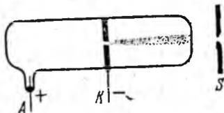
Рис. 21.6. Наблюдение явления Доплера на канальных лучах.
