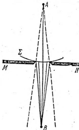
Рис. 8.11. Схема дифракции на круглом отверстии.
