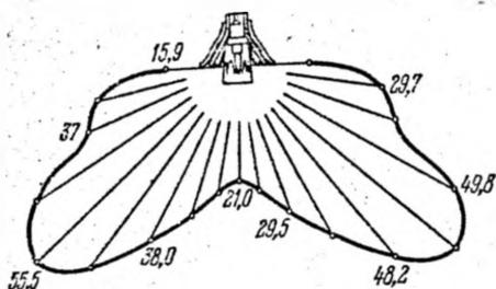
Рис. 3.13. Полярная диаграмма силы света лампы накаливания в арматуре. (Цифры выражают силу света по данному направлению в условных единицах).
