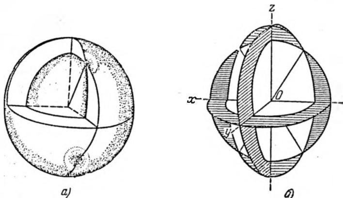
Рис. 26.7. Трехмерная модель поверхности волны в двусном кристалле (а) и перспективное изображение трех главных ее сечений (б).
