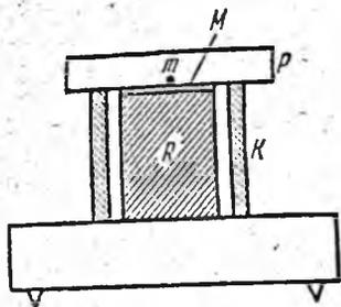
Рис. 7.11. Схема интерференционного дилатометра.
