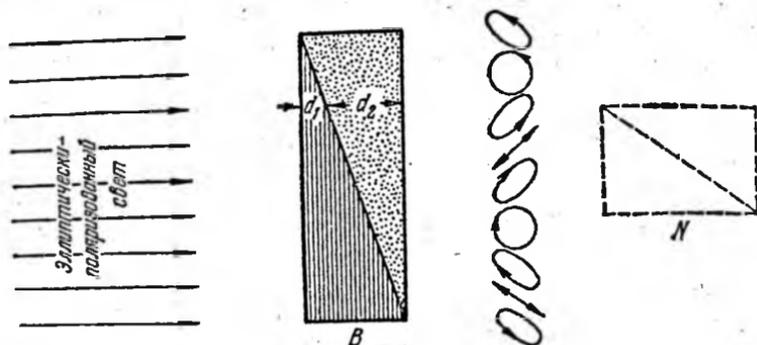
Рис. 18.5. Анализ эллиптически-поляризованного света с помощью компенсатора и поляризатора.
