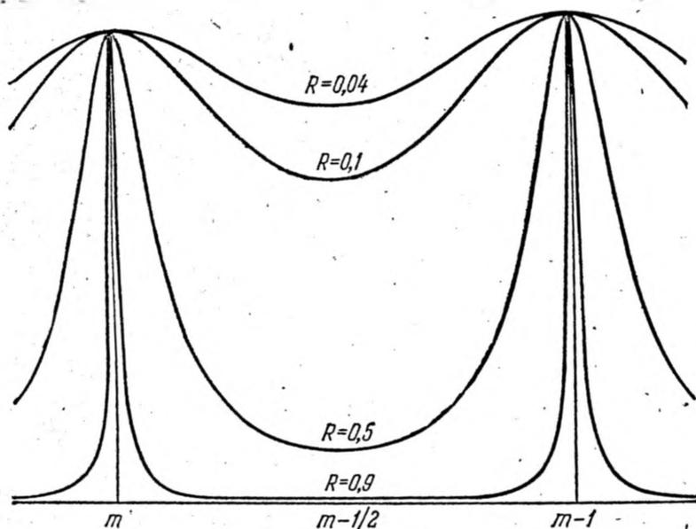
Рис. 7.3. Кривые распределения интенсивности в проходящем свете в зависимости от порядка интерференции  $m$  при разных коэффициентах отражения  $R$ .
