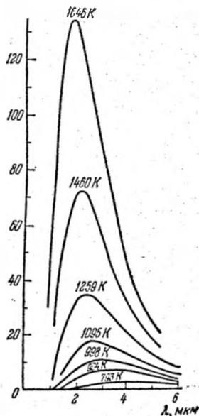
Рис. 36.9. Кривые распределения энергии в спектре черного тела для разных температур.
