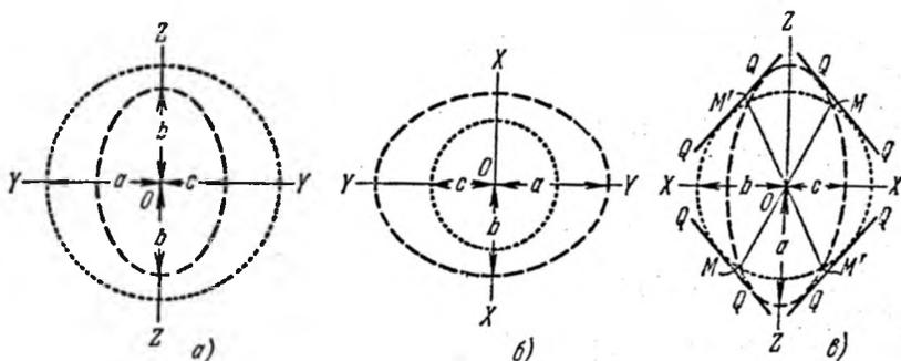
Рис. 26.6. Поверхность волны в двусном кристалле.
