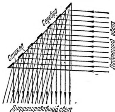
Рис. 9.23. Фазовая отражательная решетка, использующая различие в изменении фазы при полном внутреннем отражении от стекла и серебра.
