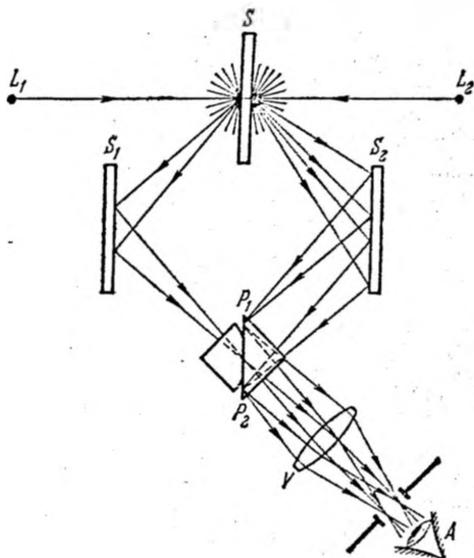
Рис. 3.12. Схема фотометра Люммера — Бродхуна.
