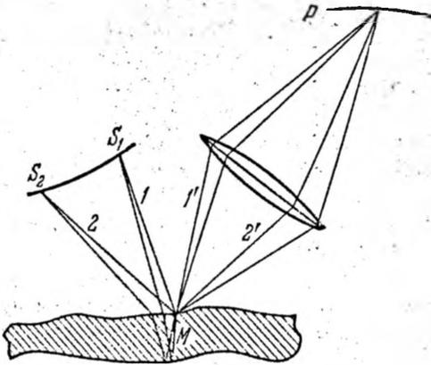
Рис. 6.1. К вопросу об интерференции в тонкой пленке при протяженном источнике света.
