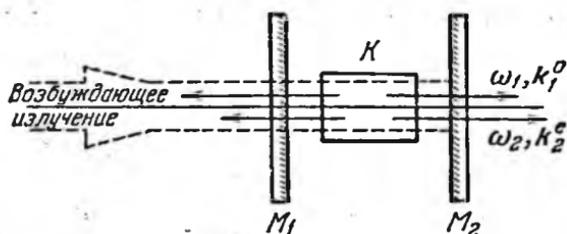
Рис. 41.13. Схема параметрического генератора света.
