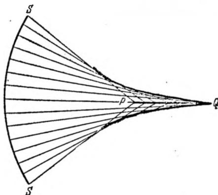
Рис. 13.1. Сечение каустической поверхности.
