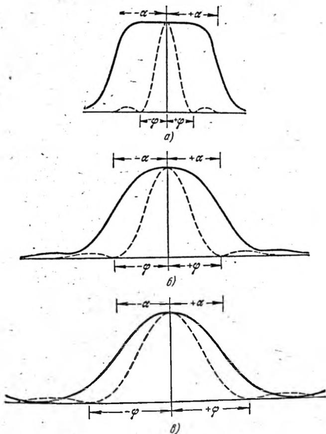
Рис. 9.6. Дифракция при угловой ширине источника  $2\alpha$  на щели шириной  $b$ . Сплошная линия — изображение источника, пунктирная линия — изображение точки, расположенной в центре источника,  $a$  — широкая щель,  $\varphi = \lambda/b < \alpha$ ;  $b$  — более узкая щель,  $\varphi = \lambda/b = \alpha$ ;  $v$  — узкая щель,  $\varphi = \lambda/b > \alpha$ .
