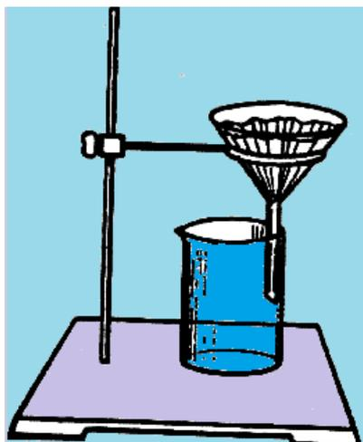
Рис. 2.31. Установка для фильтрации через стеклянную воронку
