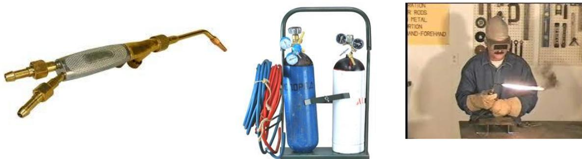
*Рис. 1.2. Применение ацетилена для сварки и резки металлов*
