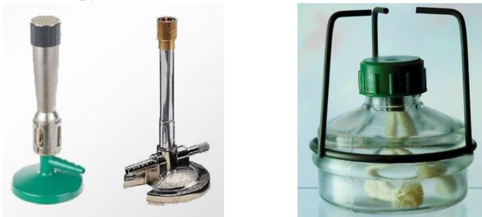
*Рис. 2.21. Газовые горелки и спиртовка*
