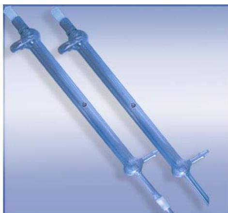
*Рис. 2.11. Обратный шариковый холодильник и холодильник Либиха*
