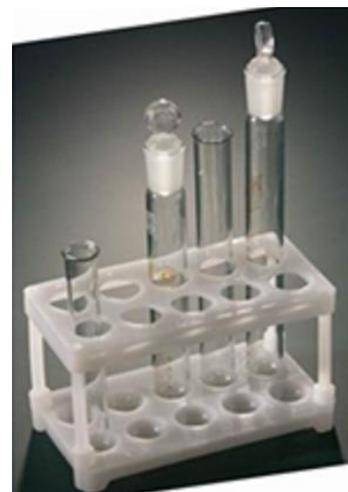
Рис. 2.14. Мерные пробирки
