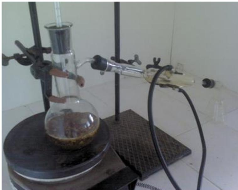
*Рис.2.34. Прибор для простой перегонки :*
