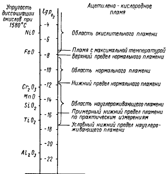
Рис. II.11. Номограммы сопоставления областей различной регулировки ацетилено-кислородного пламени и упругости диссоциации окислов различных элементов при 1580°С
