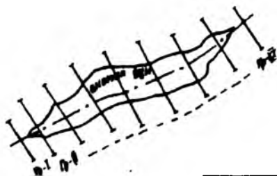
313-расм. Аниқланган аномал майдонни батафсил гамма-спектрометрик текшириш.
