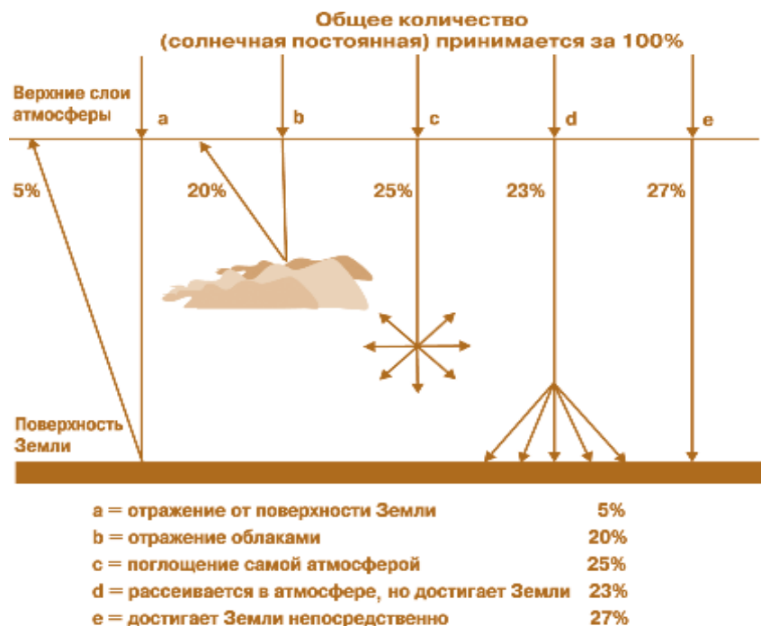
Рис. 1. Прохождение солнечных лучей через атмосферу Земли: 1 – отражение от поверхности Земли; 2 – отражение облаками; 3 – поглощение самой атмосферой; 4 – рассеивание атмосферой с достижением земной поверхности; 5 – доля излучения, достигающая поверхности Земли
