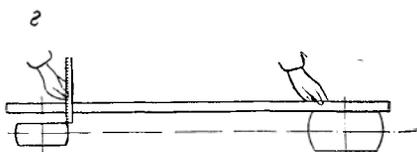
Рис. 114. Выверка валов при ременной и клиноременной передачах
