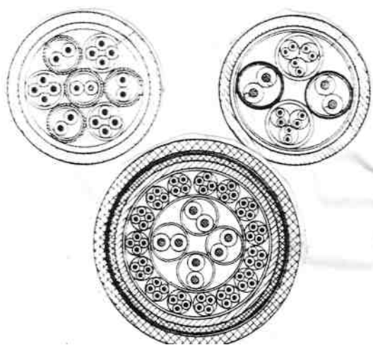
41- rasm. Past chastotali aralash uzoq aloqa kabellari konstruktsiyasi.
