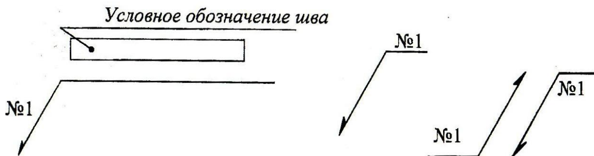
Рис. 8.19. Условные обозначения одинаковых швов
