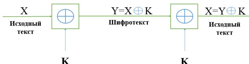
(рис.2.7.4). Схема системы шифрования Вернама
