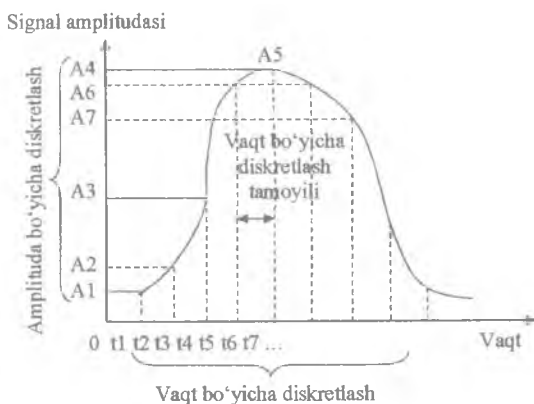
10.8-rasm. Uzluksiz jarayonni diskret modulatsiyalash.
