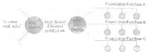
16.16-rasm. Yuqori tezlik Ethernet va Foundation Fieldbus.
