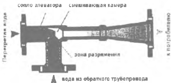
Рис.2.1. Схема водоструйного элеватора.
