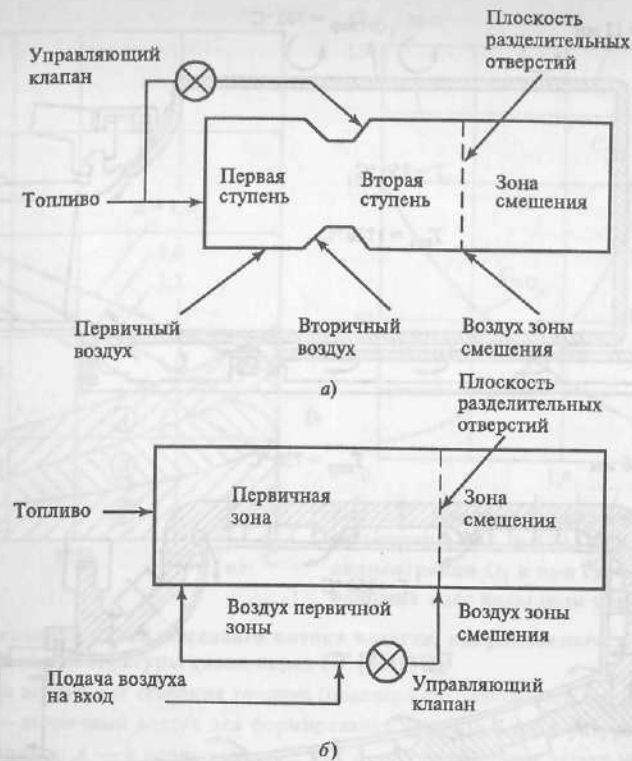
Рис. 3.8. Схемы разделения рабочего тела в КС по топливу (а) и по воздуху (б)
