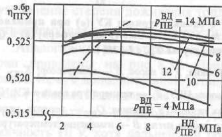
Рис. 8.56. Изменение КПД производства электроэнергии ПГУ с двухконтурным КУ при постоянной температуре пара T_{\text{ПЕ}}^{\text{ВД}} = 525 \text{ }^\circ\text{C} в зависимости от давления пара НД p_{\text{ПЕ}}^{\text{НД}} . Технические данные ГТУ приведены в табл. 8.1; давление пара в конденсаторе ПТ p_{\text{к}} = 6 \text{ кПа}
