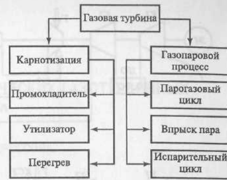
Рис. 1.17. Приближение реальных циклов газотурбинного и комбинированного газопарового процессов к циклу Карно
