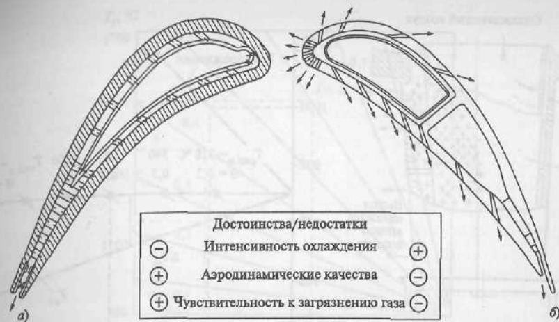
Рис. 4.38. Достоинства и недостатки конвективного и отражательного охлаждения (а) по сравнению с пленочным охлаждением (б) лопаточного аппарата ГТ
