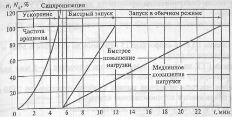
Рис. 5.30. Режим запуска ГТУ типа GT-13E2 (фирмы ABB)
