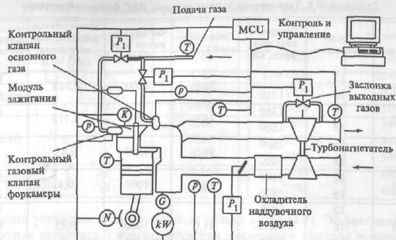
Рис. 10.38. Схема системы контроля и регулирования подачи воздуха и топлива в современных газовых ДВС фирмы «Вяртсиля» MCU — модуль управления; P_1 — регулирующий орган; T — датчик температуры; p — датчик давления; K — датчик детонации; N — датчик мощности цилиндра; G — датчик мощности двигателя в целом
