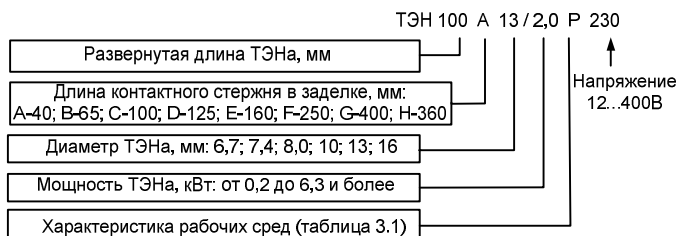
Рис. 3.2. Структура условного обозначения ТЭНов
