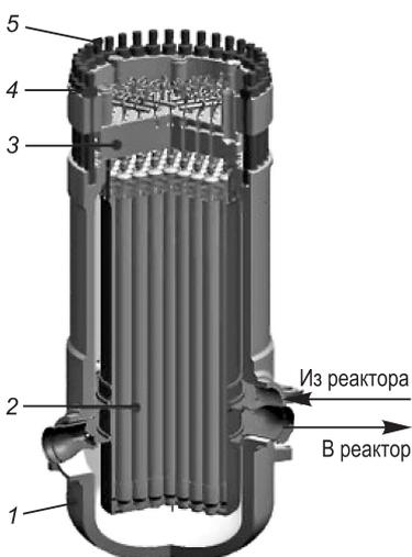
В верхней части обечайки трубной системы выполнены окна для входа греющего теплоносителя.
