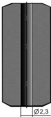
Рис. 2.6. Конструкция топливной таблетки  $UO_2$
