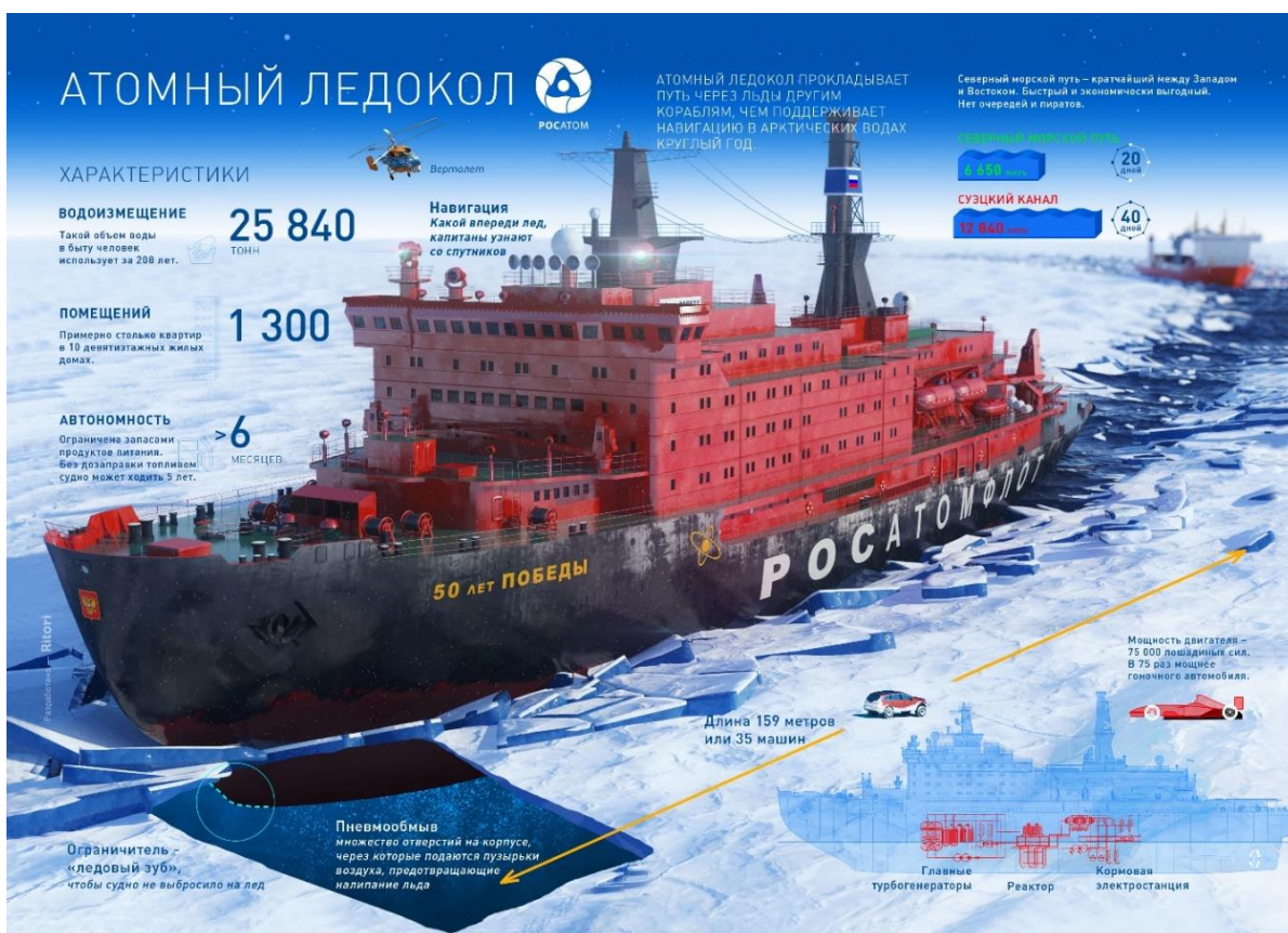
Рисунок 2 – Атомный ледокол с двухреакторной ядерной энергетической установкой мощностью 75 тыс. л.с. [81]
