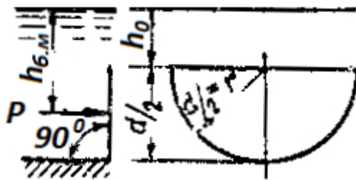
2.23-rasm. Yarim doira shaklidagi ko‘rinishga ega tekis sirtga ta’sir etuvchi gidrostatik bosim kuchi
