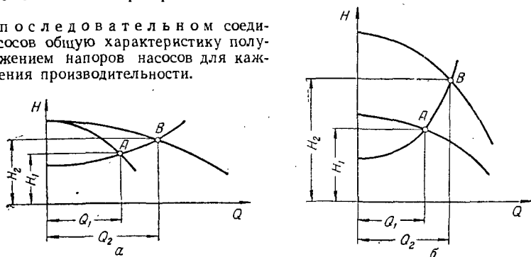
Рис. III-9. Совместная работа насосов:
