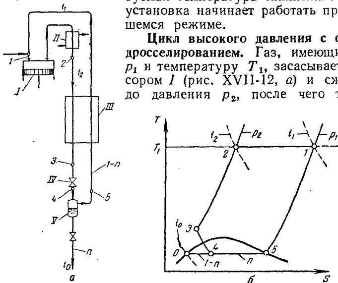
Рис. XVII-12. Регенеративный цикл высокого давления с однократным дросселированием:
