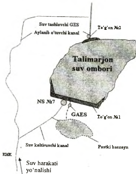
2.5-rasm. Talimarjon gidroenergetika majmuasi
