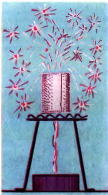
50-расм. Темир куюндисидан темирнинг алюминий таъсирида қайтарилиши.
