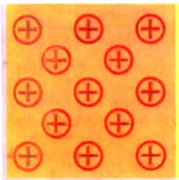
34-расм. Металл кристаллининг схематик тасвири.
