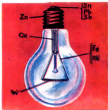
36-расм. Электрлампочка тайёрлашда ишлатиладиган металллар.
