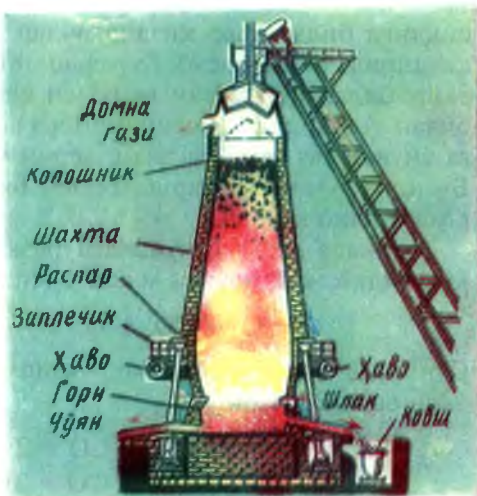
51-расм. Домна печи (схемаси).
