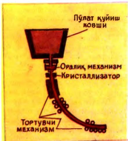
58-расм. Пўлатни узлуксиз қуйиш.
