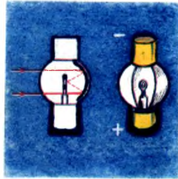
43-расм. Электр кўз: чапда — кесими; ўнгда — умумий кўриниши.
