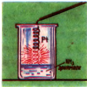
13-расм. Аммиакнинг каталитик оксидланиши.
