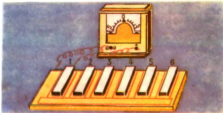
38-расм. Металларнинг электр кучланишларини ўлчаш: 1 — рух, 2 — темир, 3 — никель, 4 — қўрғошин, 5 — мис, 6 — қумуш.
