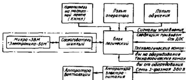
Рис. 11.28. Структурная схема системы УКМ-772
