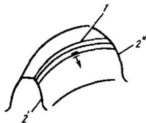
Рис. 3.20. Схема образования боковой поверхности кругового зуба конических колес: 1 — образующая; 2 и 2' — направляющие
