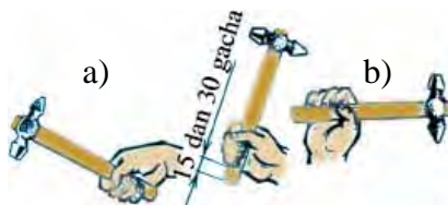
65-rasm. Kesishda bolgʻaning dastasini ushlab usullari:
