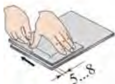
45-rasm. Tunuka listlarni tekislash qoidalari.
