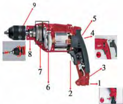
10-rasm. Elektr qo'l parmasining tuzilishi:
