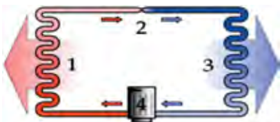
4-rasm. Muzlatkichning ishlash sxemasi.
