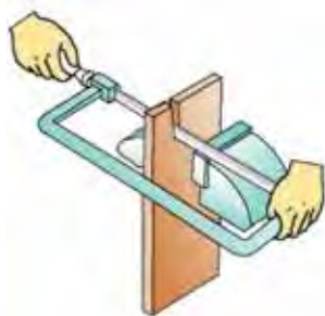
49-rasm. Uzun metallarni qirqish usuli.
