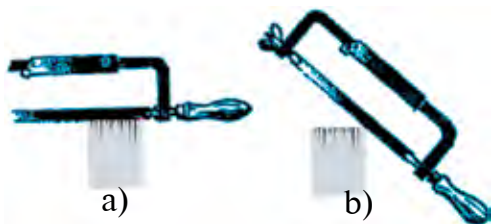
58-rasm. Qirqishni boshlashda arraning holati: a – to‘g‘ri; b – burchak ostida.
