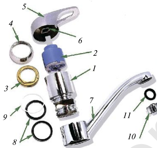
16-rasm. Bir richagli smesitel qurilmasining tuzilishi: 1 – metall korpus; 2 – kartrij; 3 – kartrijni mahkam tutib turadigan gayka; 4 – dekorativ qopqoq; 5 – smesitel dastagi; 6 – smesitel tutqichi ostida joylashgan kvadrat shaklidagi ushlagich; 7 – aylanuvchi burun; 8, 11 – rezina halqalar; 9 – ftoroplastik halqa; 10 – aerator (himoya to‘ri).
