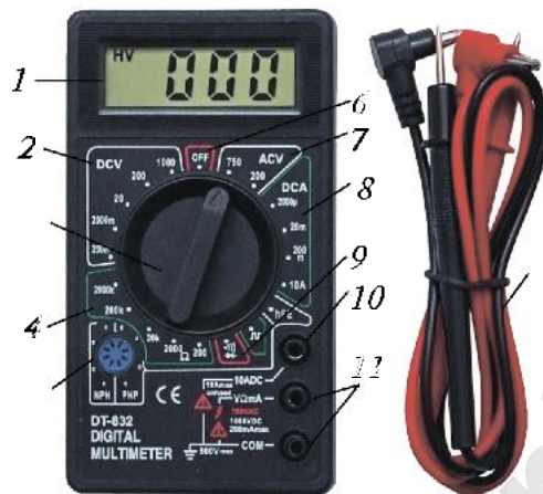
22-rasm. DT-832 markali multimetrning tuzilishi: 1 – display; 2 – o‘zgarmas kuchlanishni o‘lchash; 3 – perekluchatel; 4 – qarshilikni o‘lchash; 5 – tranzistorlarni tekshirish uyasi; 6 – o‘chirish; 7 – o‘zgaruvchan kuchlanishni o‘lchash; 8 – tokni o‘lchash; 9 – o‘zgarmas kuchlanishni o‘lchash; 10 – 10 A bo‘lgan tokni o‘lchash; 11 – aniqlagichlar uchun uyacha; 12 – o‘lchov simlari (shuplar).
