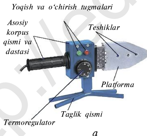
8-rasm. Plastik quvurlar uchun payvandlash asbobi: a — payvandlash asbobining tuzilishi; b — to'plam qutisi.
