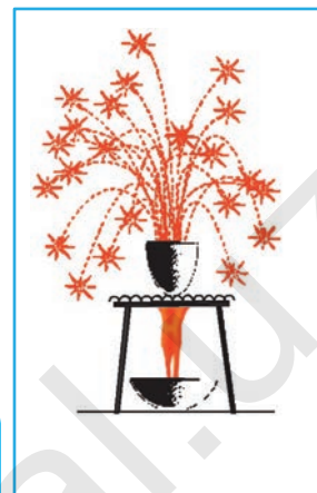
15- rasm. Aluminiy yordamida temir oksidini qaytarish.
