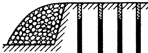
Рис. 9.20. Схема взрывания на подпорную стенку (в «зажатой среде»)
