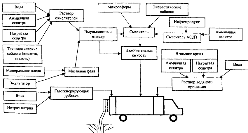
Рис. 13.14. Структурная схема изготовления на стационарном пункте эмульсионного ВВ для механизированного заряжения с накопительной емкостью:
