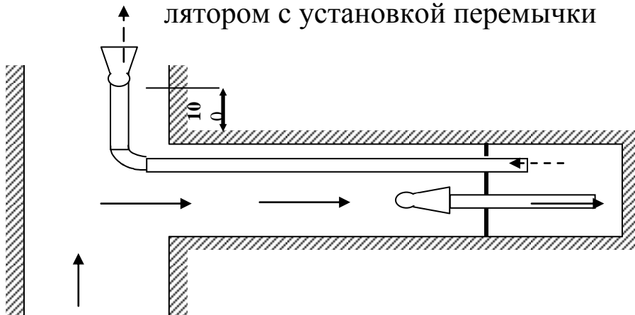
Рисунок 19.5 – Комбинированное проветривание двумя вентиляторами с установкой перемычки
