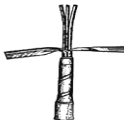
Рис. 14. Разделка свинцовой оболочки кабеля для заземления
