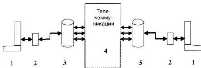
Рисунок 5.1. Структура передачи сообщения в Интернете
