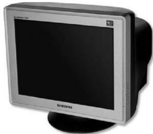
Рис. 2.5. Монитор на базе электронно-лучевой трубки
