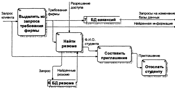
Рис. 3.6. Декомпозиция работы «Обработать запрос фирмы»
