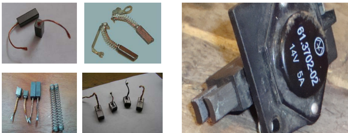
6.31 -расм. Ўзгармас ток генератори чўткаларнинг турлари (а) ва чўтканинг тутқичи (б).
