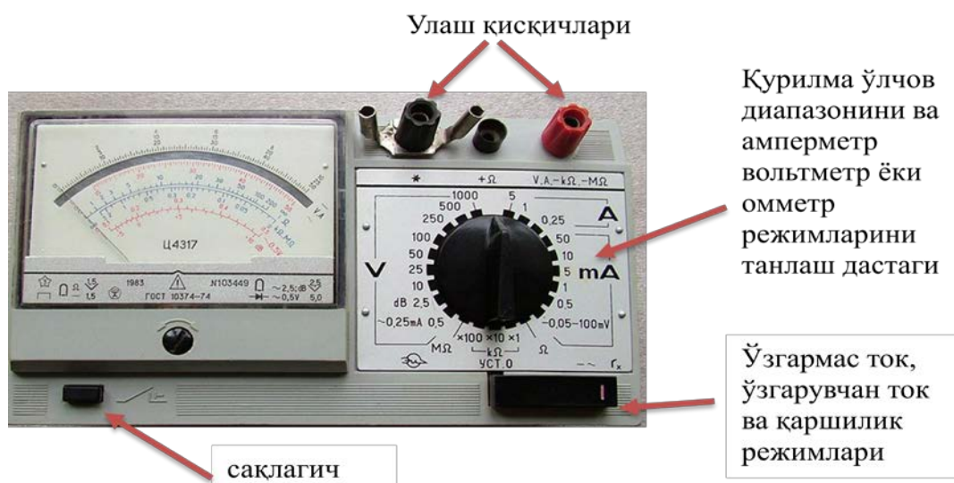
4.7- расм. Амалда энг кўп истеъмолда бўлган Ц4317 маркали универсал электр ўлчов қурилмаси.
