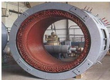
3.8- расм. Катта қувватли электр машинасининг статор ва ротор ўзаклари
