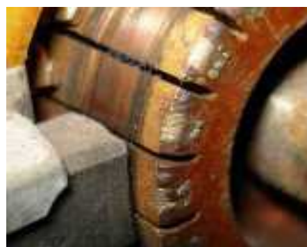
6.33- расм. Машинада чўтка ва коллектор коммутацияси.
