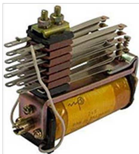
3.10- расм. Электромагнитик релели система ва реленинг умумий кўриниши.
