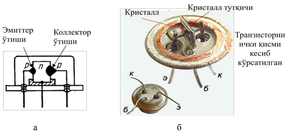
8.33-расм. p-n-p транзистори тузилиши (а) ва умумий кўриниши (б).
