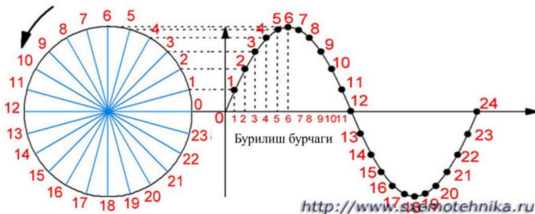
2.13-расм. Синусоидал кучланишнинг ҳосил бўлиши.
