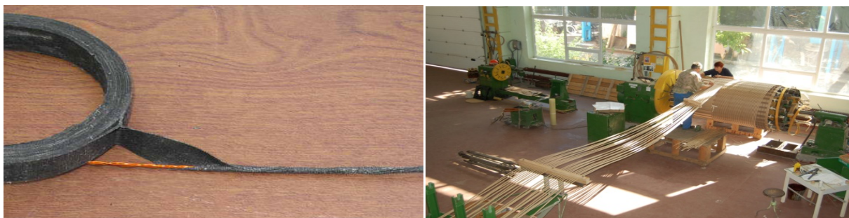
5.11- расм. Чулғам симларини изоляцияловчи ленталар билан ўраш
