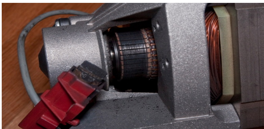
6.32- расм. Ўзгармас ток машинаси коллектор-чўтка қисми ва чўтка.
