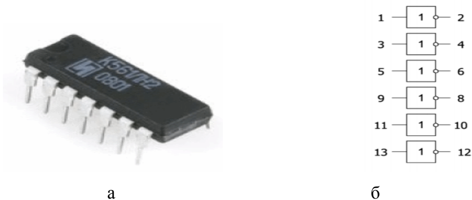
8.17-расм. К561ЛН2 микросхемада мантикий инкор операцияси. 1, 3, 5, 9, 11 и 13 – мос ҳолда 1-6 кириш; 2, 4, 6, 8, 10 и 12 – мантикий чиқишлар.
