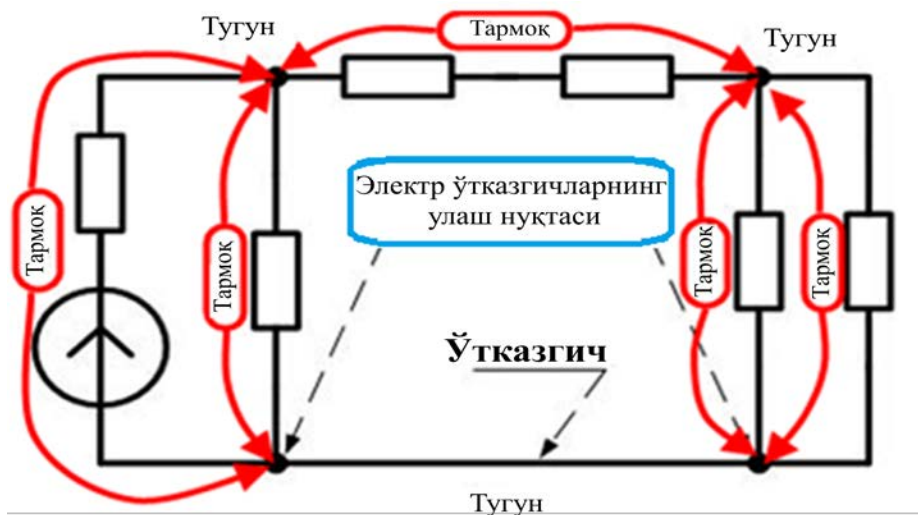
2.8-расм. Электр занжиридаги асосий тушунчалар. Тугун – узел – knot; Тармоқ - ветвь – branch; Контур - контур-contour
