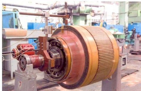
3.8- расм. Катта қувватли электр машинасининг статор ва ротор ўзаклари
