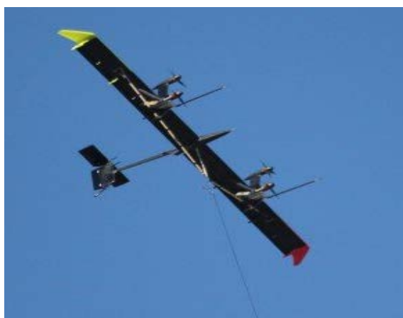
7.49-расм. Самолёт (а) ва дельтапланларга (б) ўрнатилган шамол электр қурилмалари.
