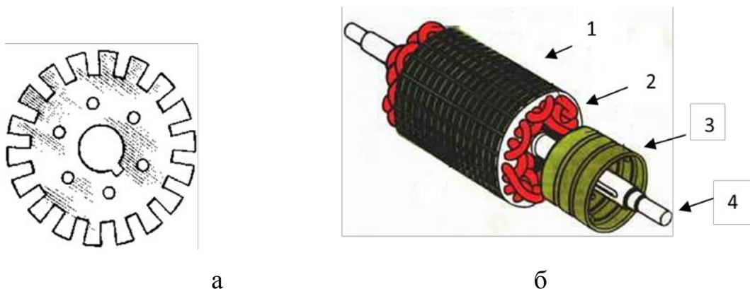
6.6-расм. Асинхрон двигателнинг фаза чулғамли ротори. а- ротор ўзаги япроқчаси, б-фаза чулғамли роторнинг умумий кўриниши: 1-ўзак, 2-чулғам,3-контакт халқалари, 4-ротор ўқи.
