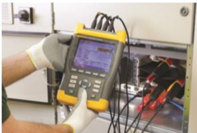
5.6-rasm. Elektr tarmoq parametrlarini tezkor aniqlash jarayoni.
