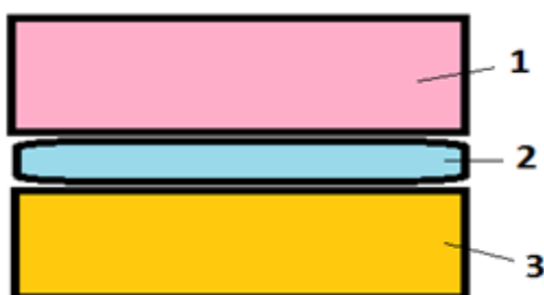
4.4-rasm. Suyuqlikli tinchlantirgich(1-aylanuvchi qism;2-suyuqlikli tinchlantirgich; 3-qo'zg'almas qism)
