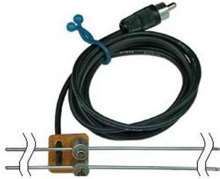
8.4-rasm. Tuproqning namligini(uning qarshiligi orqali) o'zgaruvchan tokda o'lchash uskunasining tashqi ko'rinishi.
