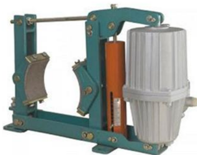
14.8-rasm. Elektromagnit tormoz qurilmasi.
