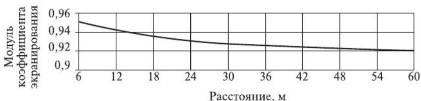
Рис. 6.22. Модуль коэффициента экранирования в зависимости от расстояния до контактной сети
