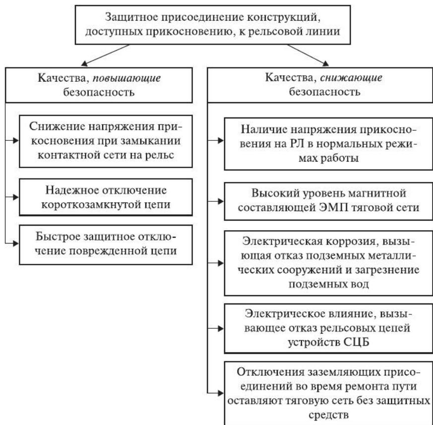
Рис. 1.13. Основные качества защитного присоединения к рельсовой линии зию (электролитическое растворение) металлов в проводящем пространстве земли и отравление подземных вод; – воздействие электрических процессов в РЛ на рельсовые цепи СЦБ; – необходимость отключения заземляющих присоединений от рельса во время ремонта пути.
