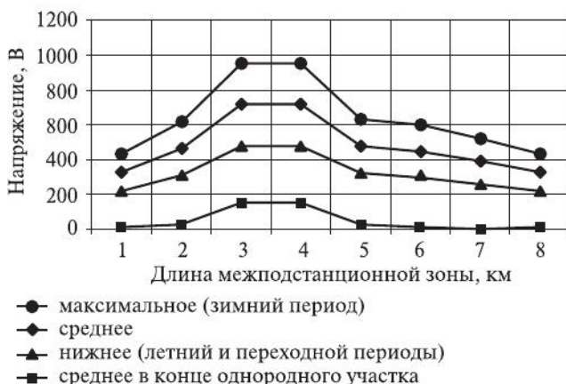
Рис. 5.34. Расчетные значения напряжений относительно нулевого потенциала при коротком замыкании на протяженное защитное ЗУ
