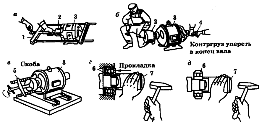
Рис. 5.2. Способы насадки шкивов и подшипников на вал: а — винтовым приспособлением; б — молотком с применением контргруза; в — снятие шкива съёмником; г — посадка подшипника в гнездо; д — посадка подшипника на вал; 1 — винтовое приспособление; 2 — шкив; 3 — электродвигатель; 4 — контргруз; 5 — съёмник; 6 — подшипник; 7 — труба с заглушкой
