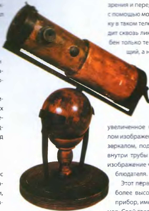
▲ Зеркальный телескоп (рефлектор). Ньютон целиком сделал его своими руками.
