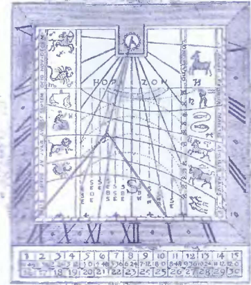
▲ Рисунок солнечных часов, которые сконструировал Ньютон, когда учился в средней школе. Чтобы сделать солнечные часы, указывающие время с помощью отбрасываемой тени, требовалось очень точно рассчитать перемещение солнца по небосводу в течение дня.
