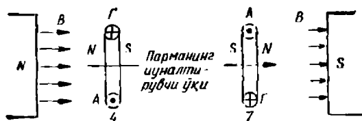
6-4- расм. Рамканинг икки ҳолати учун ташқи магнит майдон чизиқларининг ва рамка майдонининг йўналиши.
