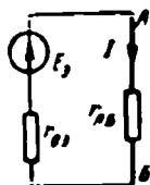
2-6-расм. 2-5-расмдаги занжир учун эквивалент кучланиш манбаининг схемаси.
