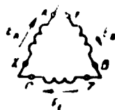
14-4- расм. Генератор чулғамларини учбурчак шаклида улаш.
